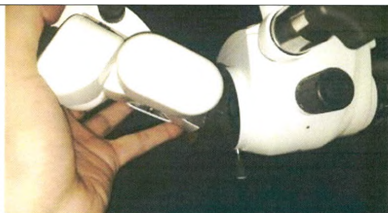
Рисунок 2.2. Совместите соединительные разъемы тубуса бинокулярного и блока оптики таким образом, чтобы насечка на тубусе бинокулярном совпала с выемкой на блоке оптики.
