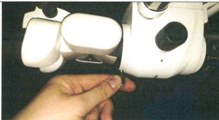
Рисунок 2.3. Закрутите соединительный винт на блоке оптики.
