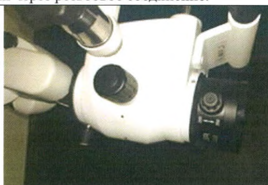
Рисунок 3.2. Закрутите резьбовое соединение, сделав несколько оборотов объектива до упора, без чрезмерного усилия. Установите на объектив стекло защитное, закрутив резьбовое соединение.
