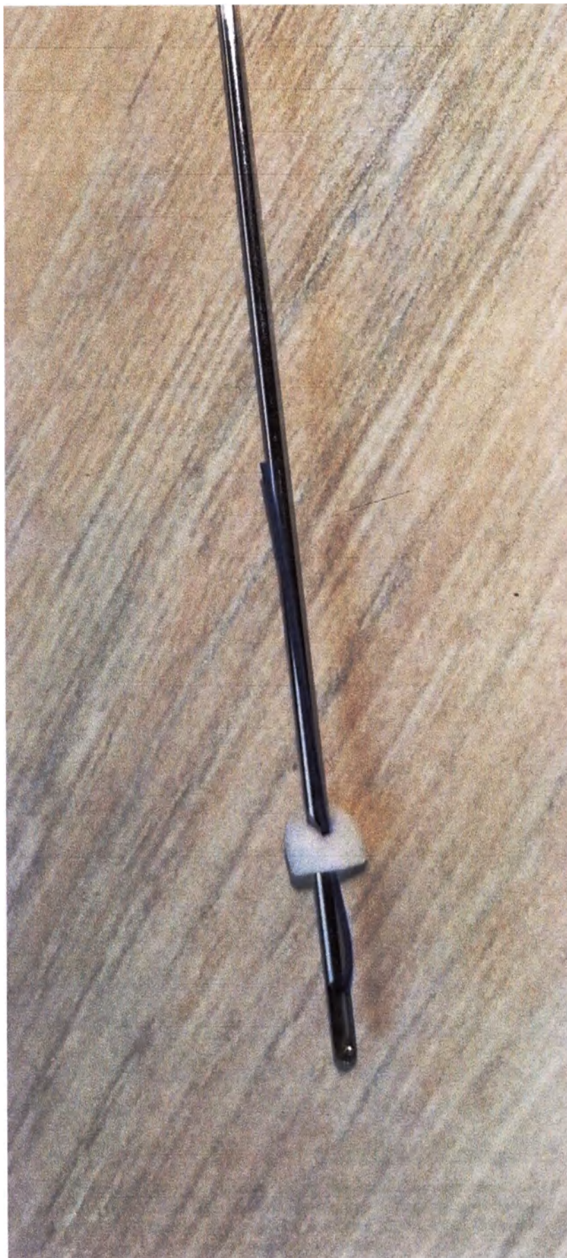
Увеличенное изображение рабочей части шпателя типа L
