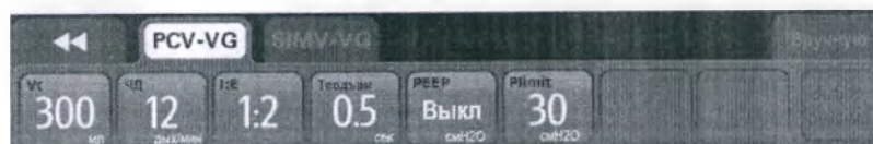
РИС. 5-11 Вентиляция с регулируемым давлением и гарантированным объемом (PCV-VG)
