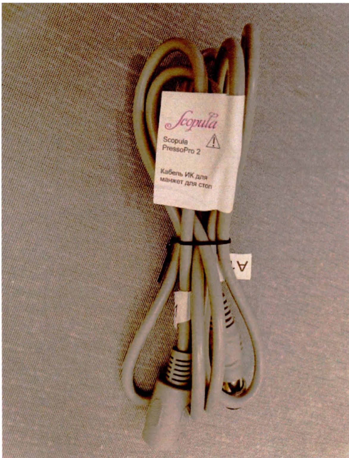
Рисунок 5.10 – Кабель ИК для манжет для стоп.
