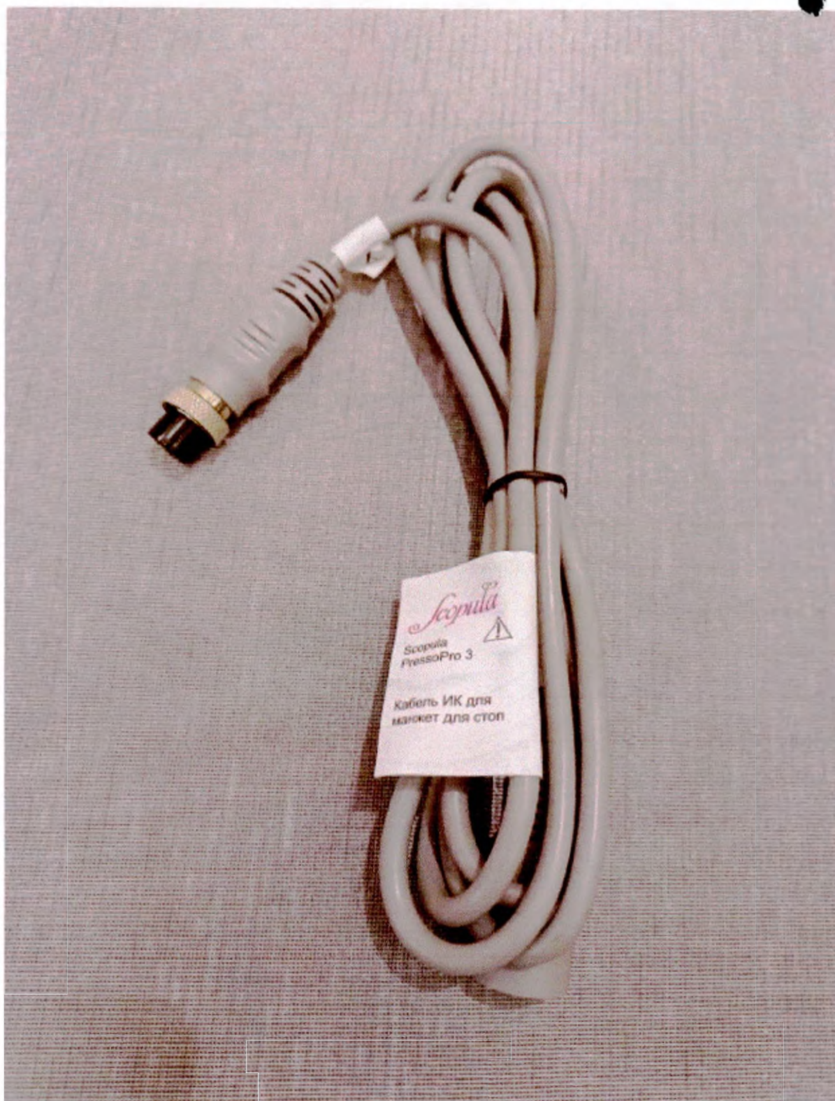
Рисунок 5.10 – Кабель ИК для манжет для стоп.
