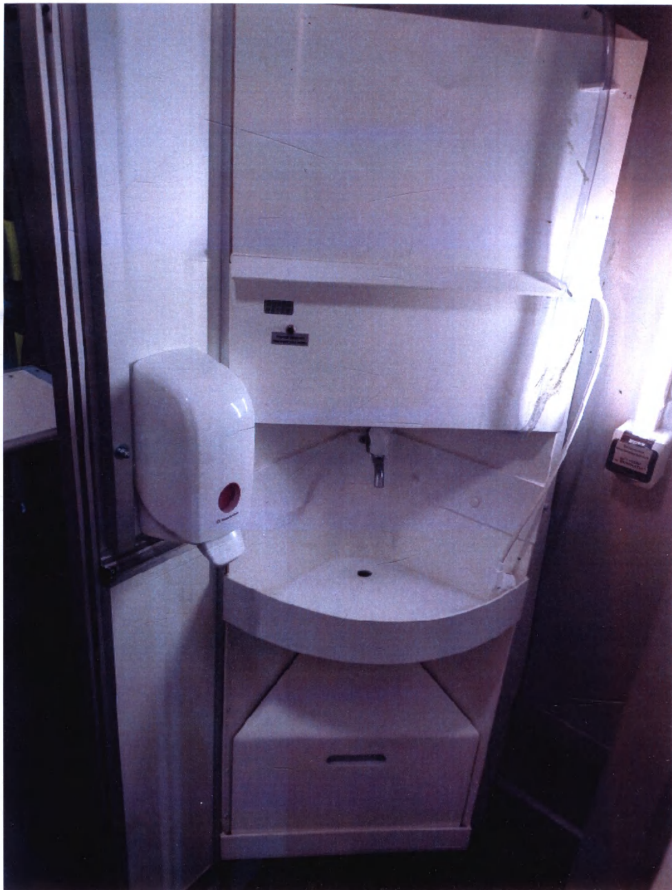
24. Умывальник с автоматическим поддержанием температуры воды в баке Тип УА 15-01 «НОКУ»
