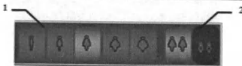
Рисунок 8. – Клавиши выбора плотности и возраста пациента
