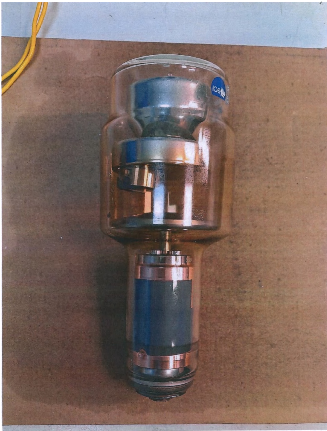
Рис 22. Рентгеновская трубка модели RTM 30 HS, производства I.A.E. SpA, Италия;
