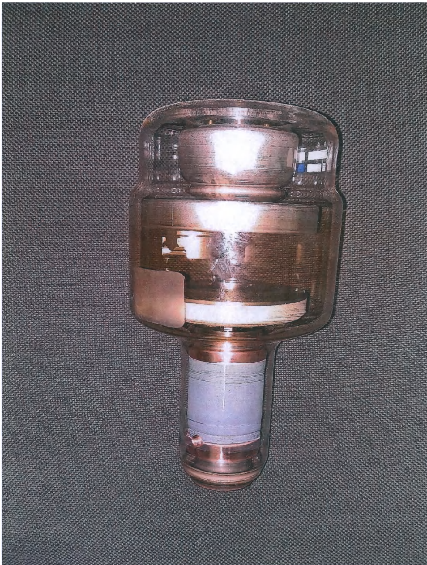
Рис 23. Рентгеновская трубка модели RTM 72 HS, производства I.A.E. SpA, Италия;
