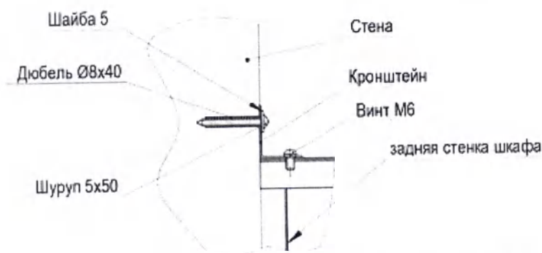
Рисунок 3 – Крепление шкафа к стене.
