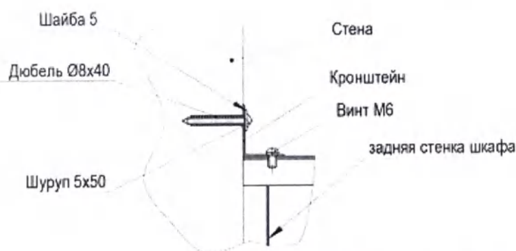
Рисунок 3 – Крепление шкафа к стене.
