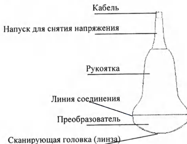
Рисунок 8-1. Краткий обзор конвексного датчика
