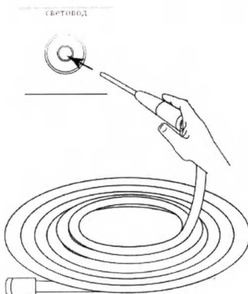
Рисунок 7.3. Схема подключения световодного жгута к гнезду адаптера присоединения световодного жгута
