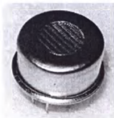
Рисунок 1. Газовый сенсор в корпусе ТО-8
