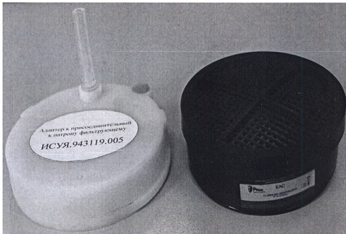
Патрон фильтрующий РПГ-67 марки А1 и Адаптер присоединительный к патрону фильтрующему
