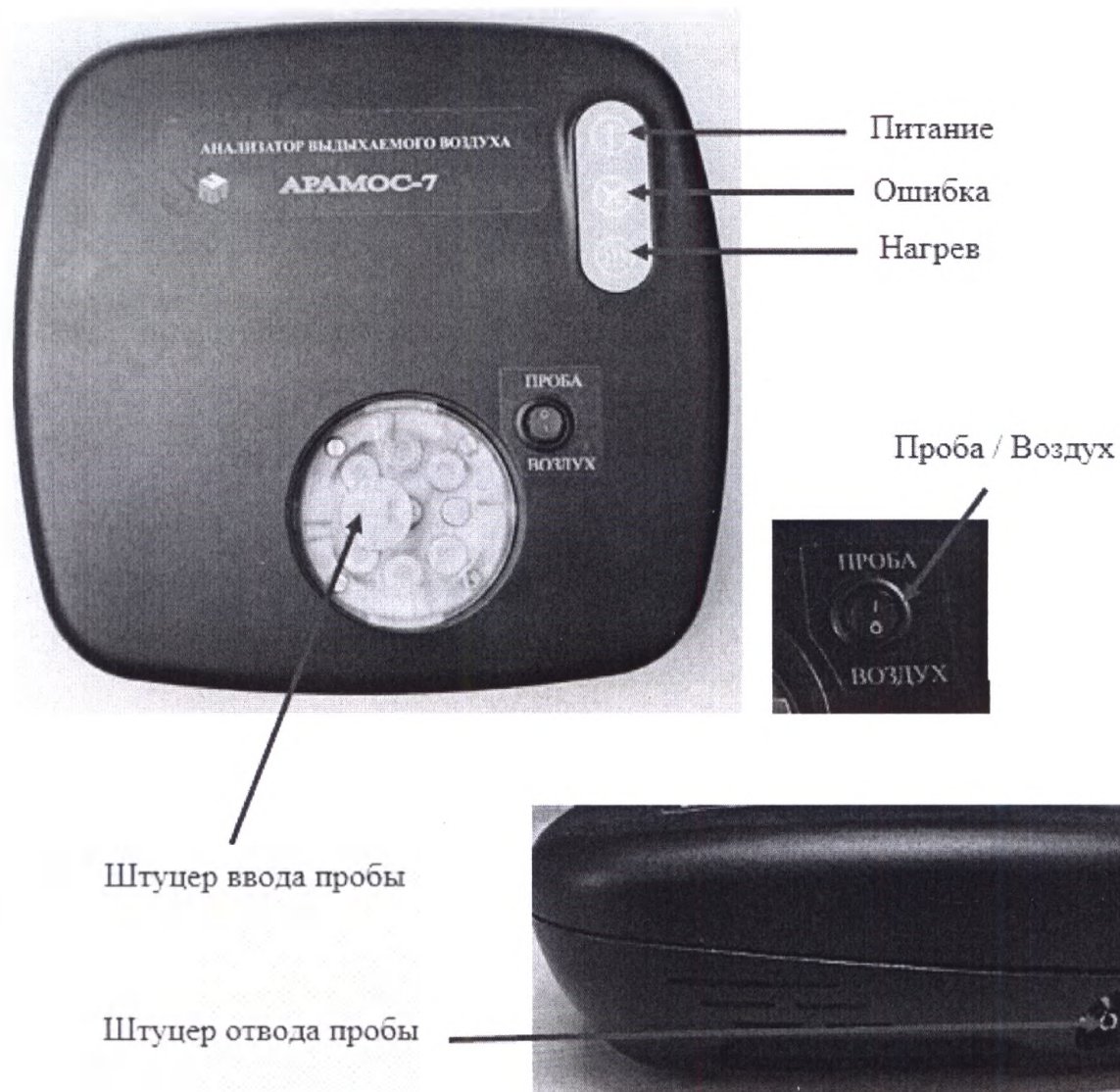
Рисунок 2. Верхняя и боковая части прибора
