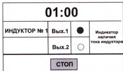
Рисунок 20 Вид экрана при подключении одного индуктора № 1
