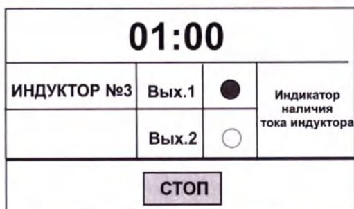
Рисунок 25 Вид экрана при подключении индуктора № 3
