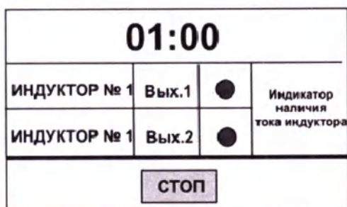
Рисунок 19 Вид экрана при подключении одновременно двух индукторов - № 1
