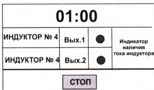
Рисунок 21 Вид экрана при подключении одновременно двух индукторов - № 2
