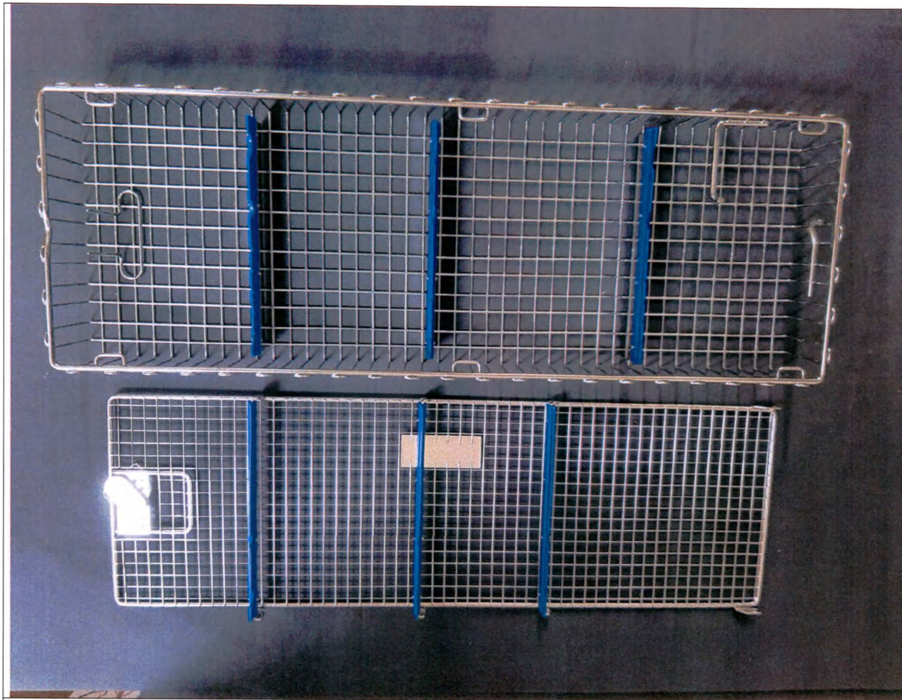
Рис. 111. Контейнер проволочный для дезинфекции/стерилизации/хранения, размеры: 640 x 216 x 78 мм.
