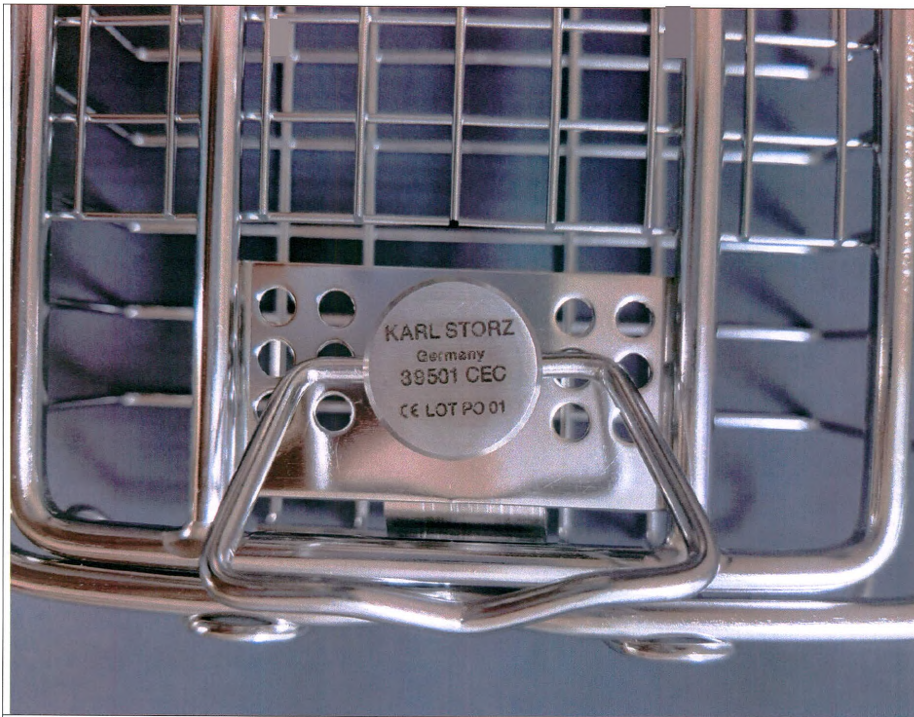
Рис. 62. Контейнер проволочный для дезинфекции/стерилизации/хранения, размеры: 604 x 125 x 54 мм.
