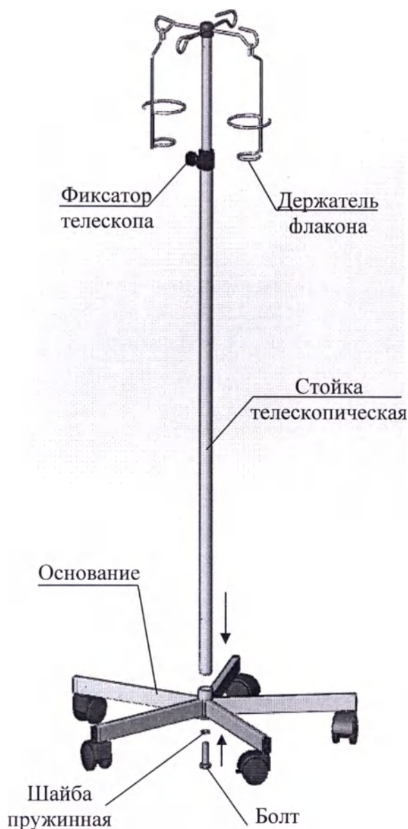
Рисунок 1 Штатив для длительных вливаний ШДВП-2 (схема сборки)
