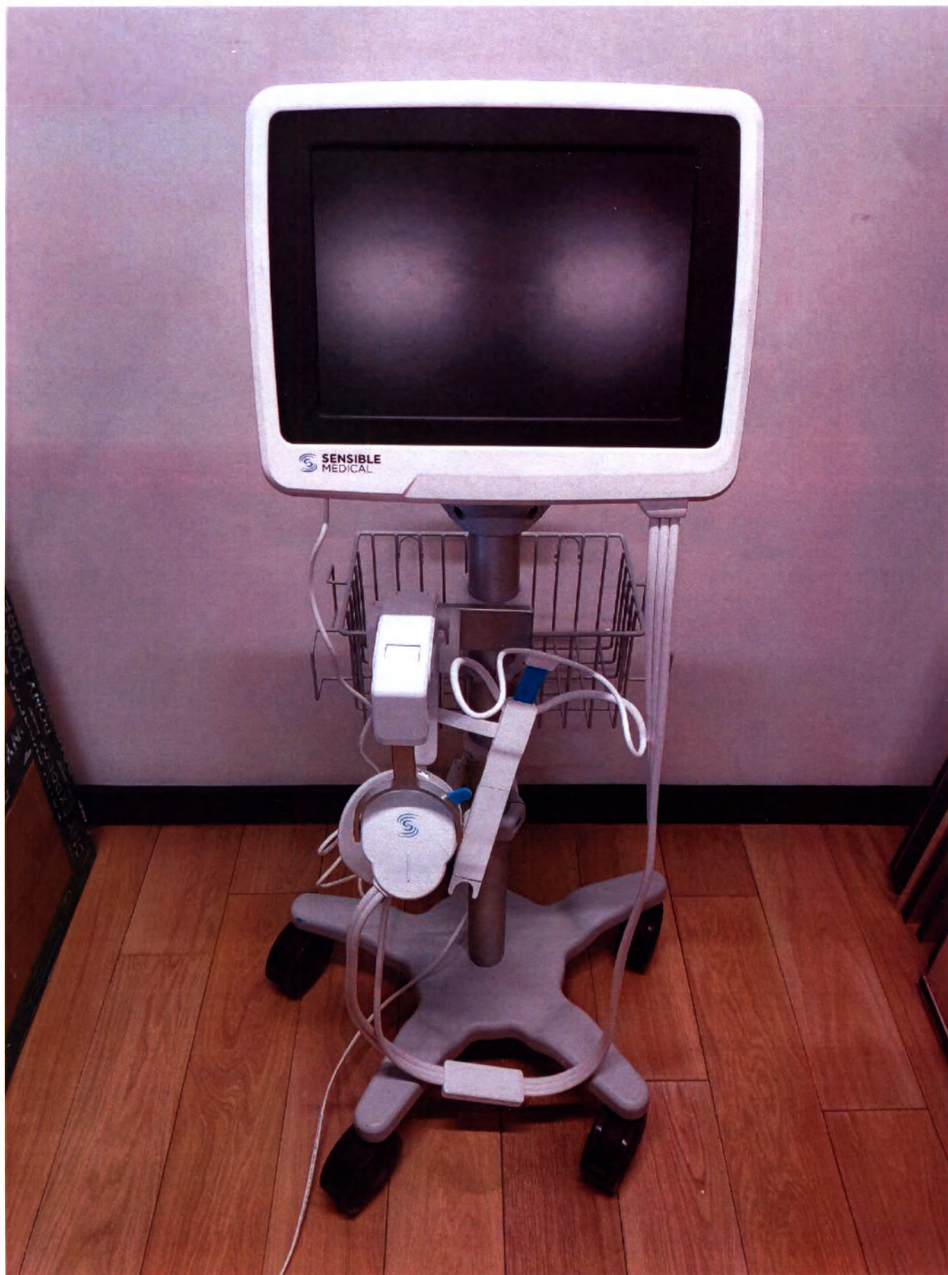
Рис.1. Система для неинвазивного измерения жидкости в лёгких ReDS Pro, модель C* (компьютер с сенсорным дисплеем, блок датчиков, тройной кабель, установлено на передвижную тележку), вид спереди
