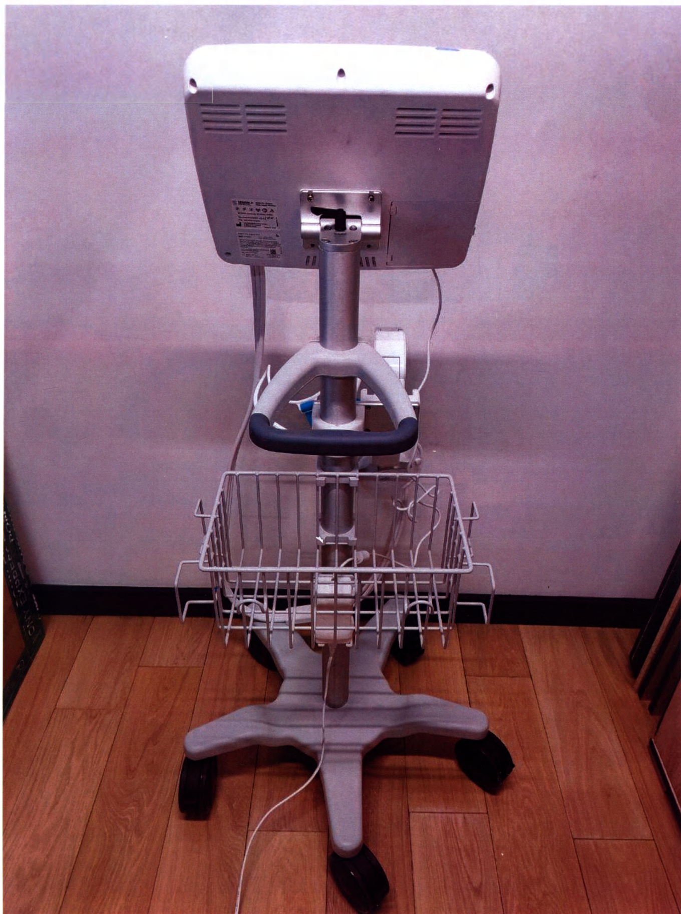
Рис.2. Система для неинвазивного измерения жидкости в лёгких ReDS Pro, модель С (компьютер с сенсорным дисплеем, блок датчиков, тройной кабель, установлено на передвижную тележку), вид сзади
