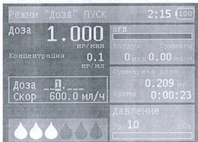
Рисунок 26. Изменение параметра «Доза» без остановки инфузии
