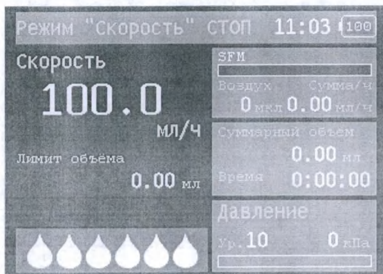
Рисунок 23. Состояние «Стоп», режим «Инфузия по скорости»
