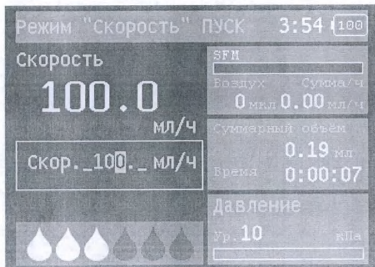
Рисунок 25. Изменение параметра «Скорость» без остановки инфузии
