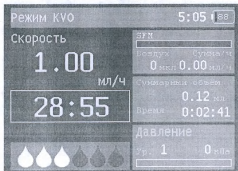
Рисунок 35. Отображение оставшегося времени в режиме KVO
