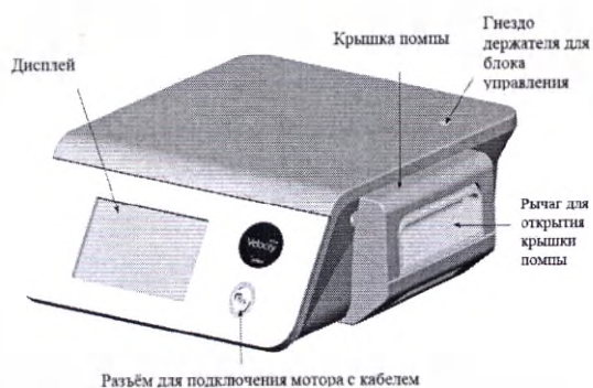
Рисунок 3. Фронтальная часть блока управления системы Velocity Alpha.
