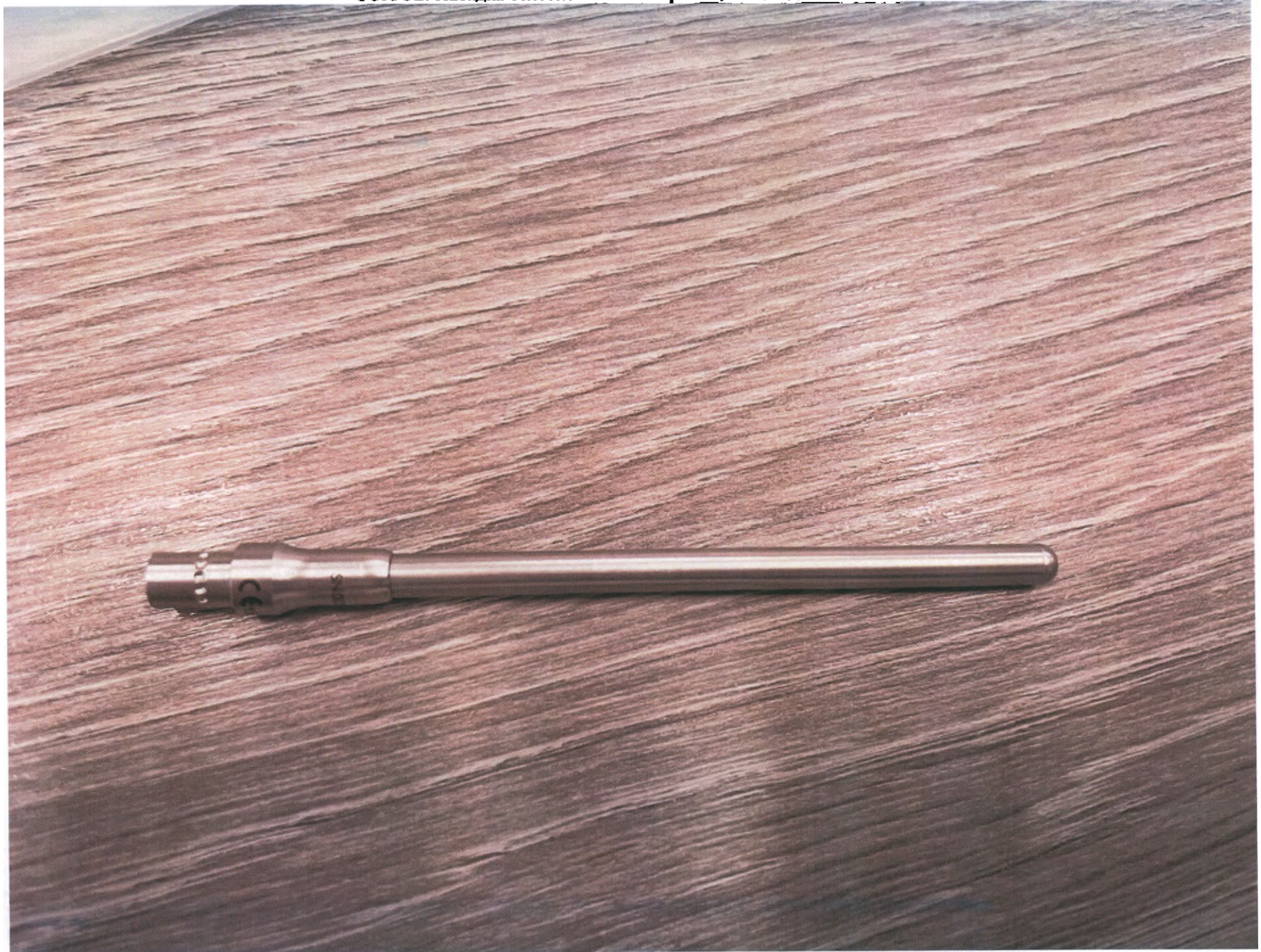
Фото 32. Насадка телескопическая прямая, общая длина 90 мм.
