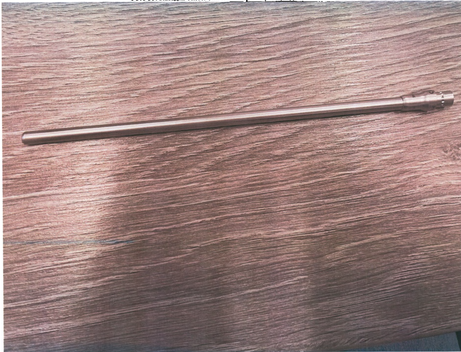
Фото 35. Насадка телескопическая прямая, общая длина 180 мм.
