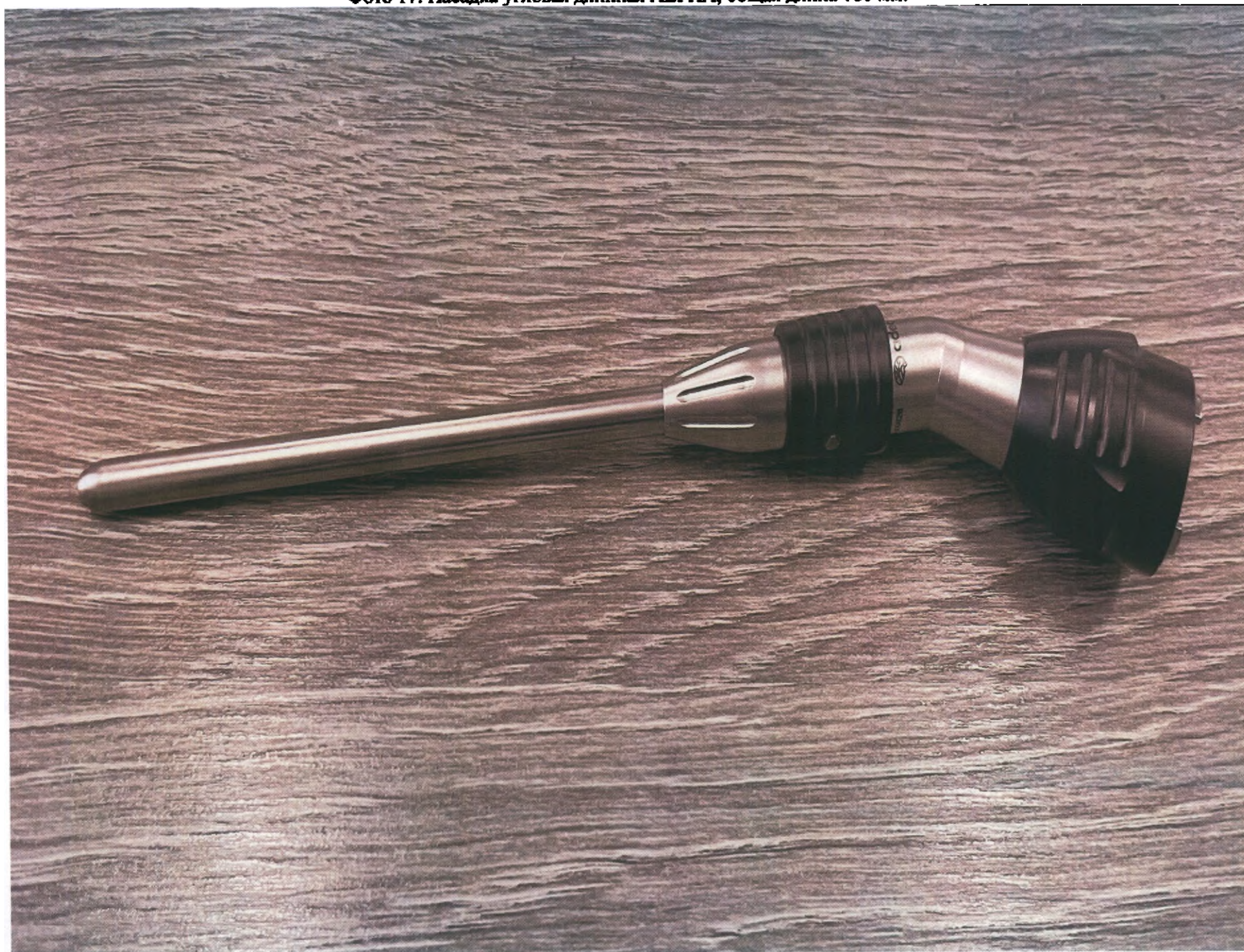
Фото 17. Насадка угловая длинная ALPHA, общая длина 180 мм.
