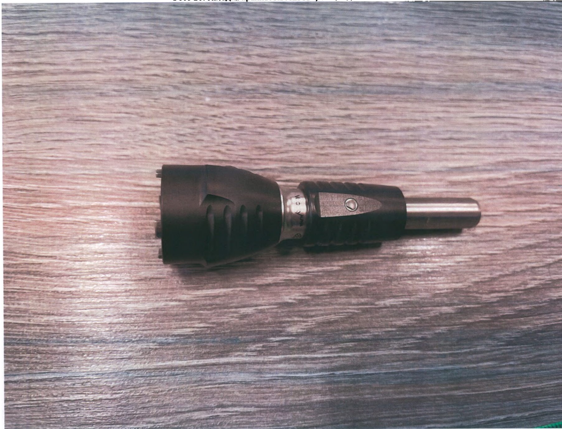
Фото 21. Насадка краниотом ALPHA, общая длина 78мм.
