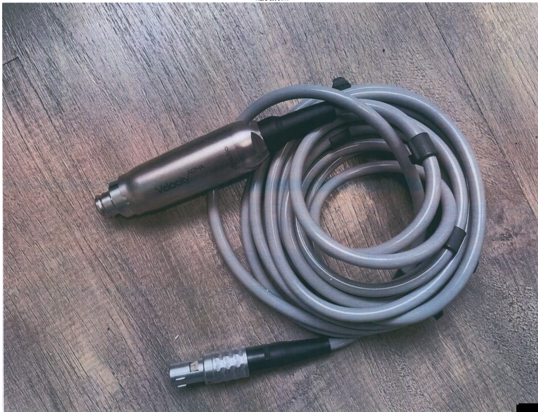
Фото 4. Система высокоскоростная Velocity Alpha для проведения хирургических операций, в составе: мотор системы 1000-80000 об/мин с 3,5 метровым кабелем.
