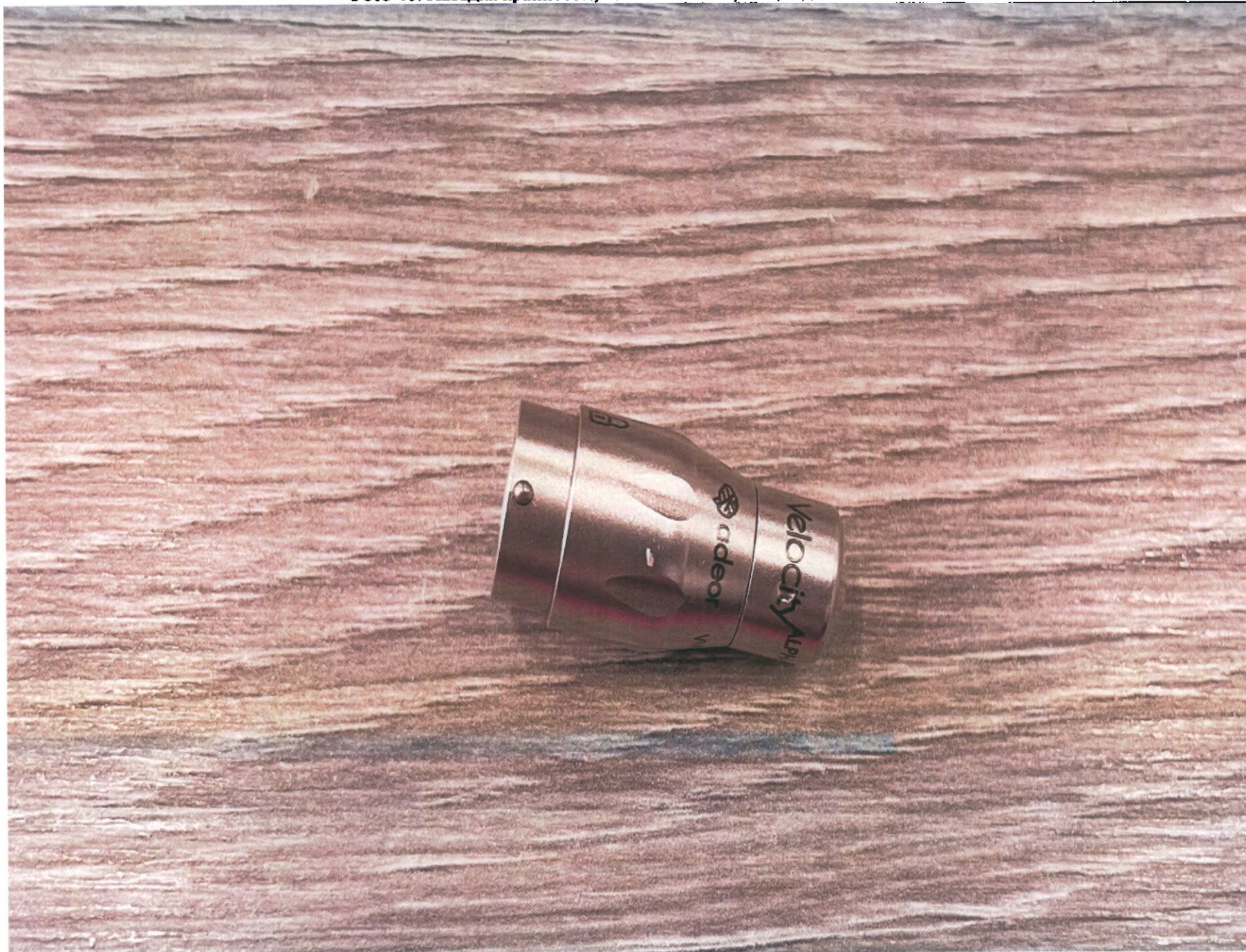
Фото 40. Насадка краннотом, головная часть, общая длина 27 мм
