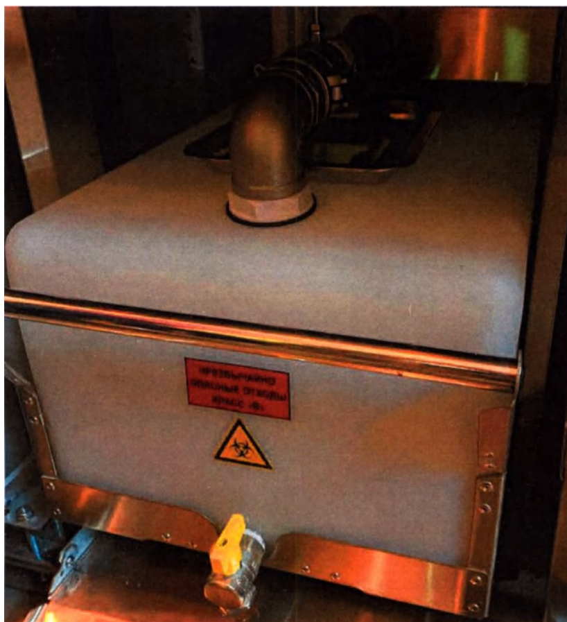
Рисунок 41 – Бак для сбора медицинских отходов класса «В» (применимо к вариантам исполнения «Titan Advanced», «Titan Premium», «Titan Ultra»)
