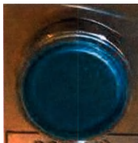
Рисунок 42 – Индикация работы водяного контура (применимо к вариантам исполнения «Titan Medium», «Titan Extra», «Titan Premium», «Titan Ultra»)
