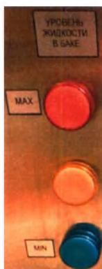
Рисунок 40 – Индикация уровня заполнения бака для сбора медицинских отходов класса «В» (применимо к вариантам исполнения «Titan Advanced», «Titan Premium», «Titan Ultra»)
