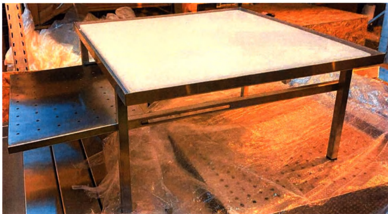
Рисунок 14 – Столик для органов с выдвижной полкой для инструментов «Element»
