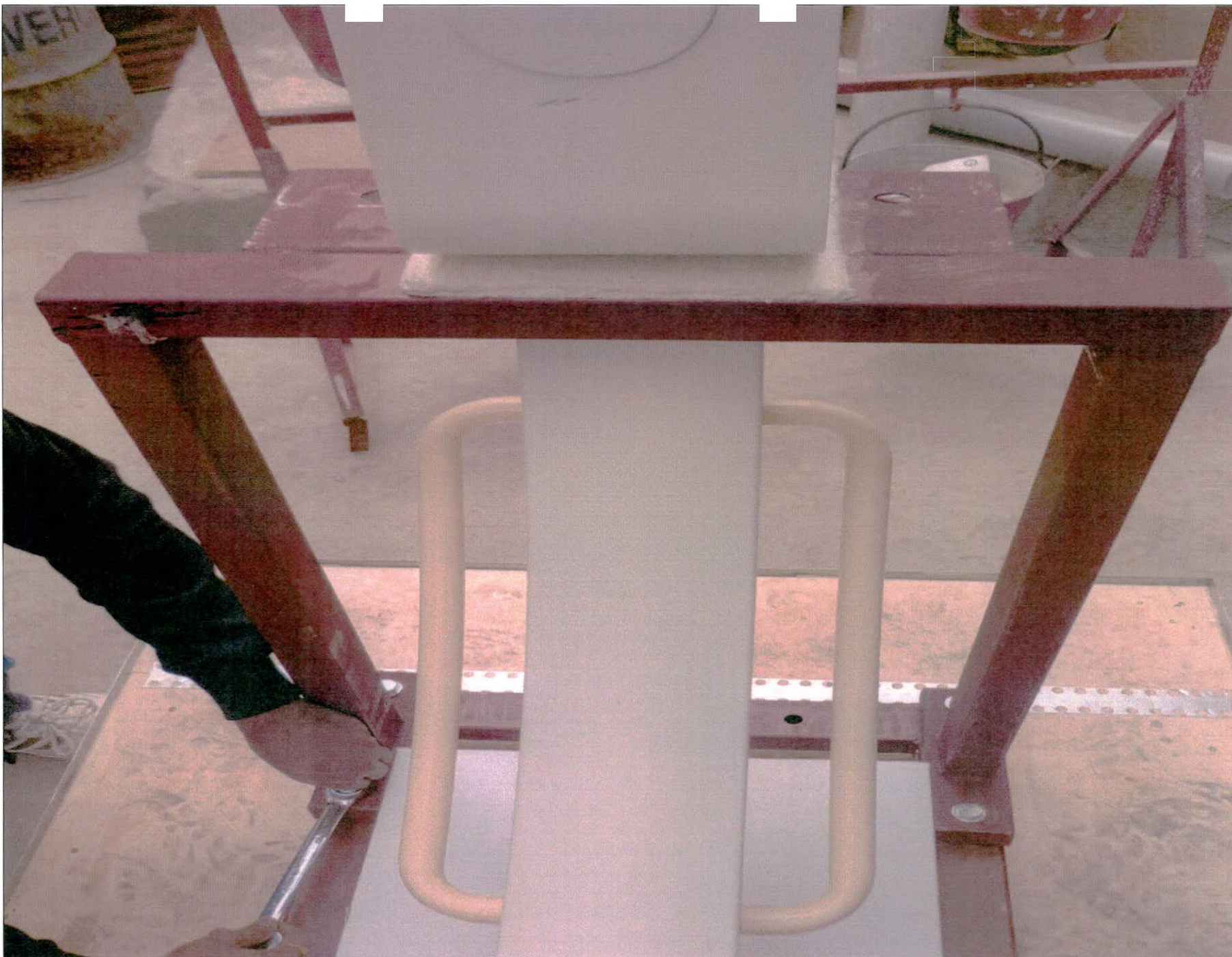
1. b) Закрепление стойки С-дуги на поддоне
