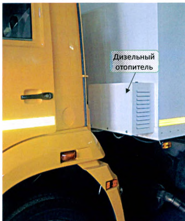
Рисунок 8 – Расположение дизельного отопителя
