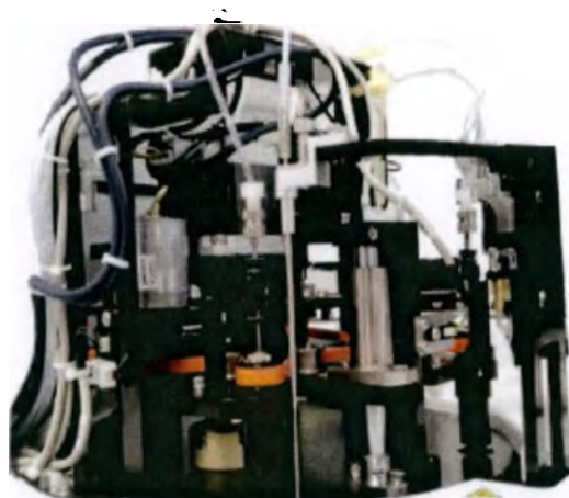
Рисунок 29. Система промывки с магнитной сепарацией
