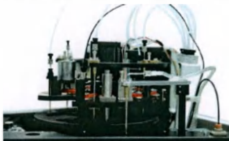
Рисунок 26. Система промывки с магнитной сепарацией
