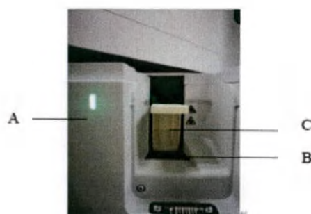
А– Индикатор состояния образцов В– Направляющие системы транспортировки штативов С. Штатив на 16 пробирок для загрузки образцов в анализатор Рисунок 5. Зона загрузки штатива системы подачи штативов
