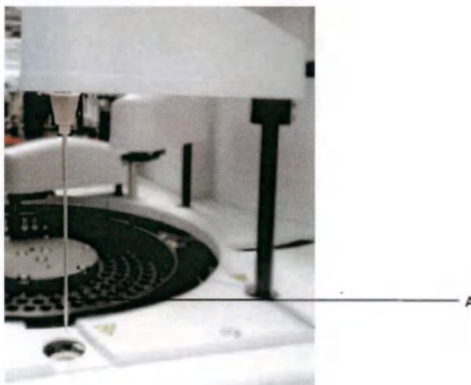
A – игла пробозаборника Рисунок 104. Пробозаборник
