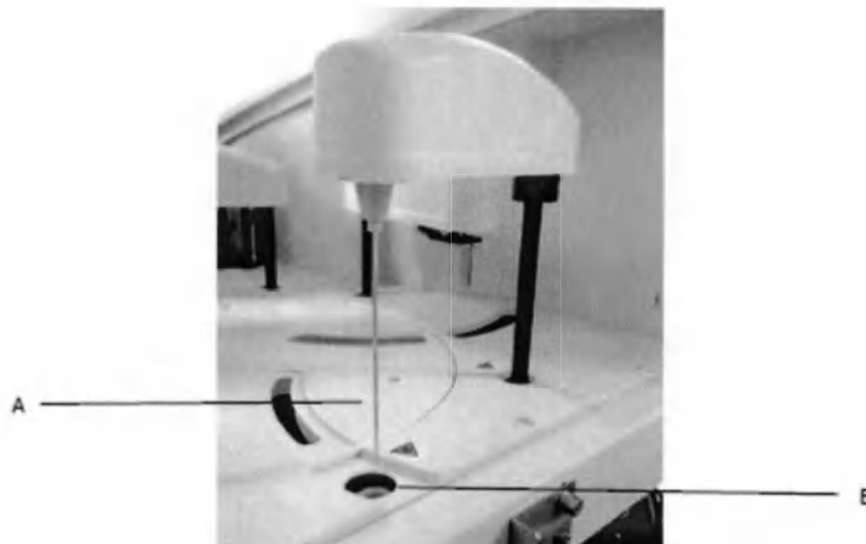
А – пробозаборник В – промывочная станция пробозаборника Рисунок 106. Пробозаборник с промывочной станцией
