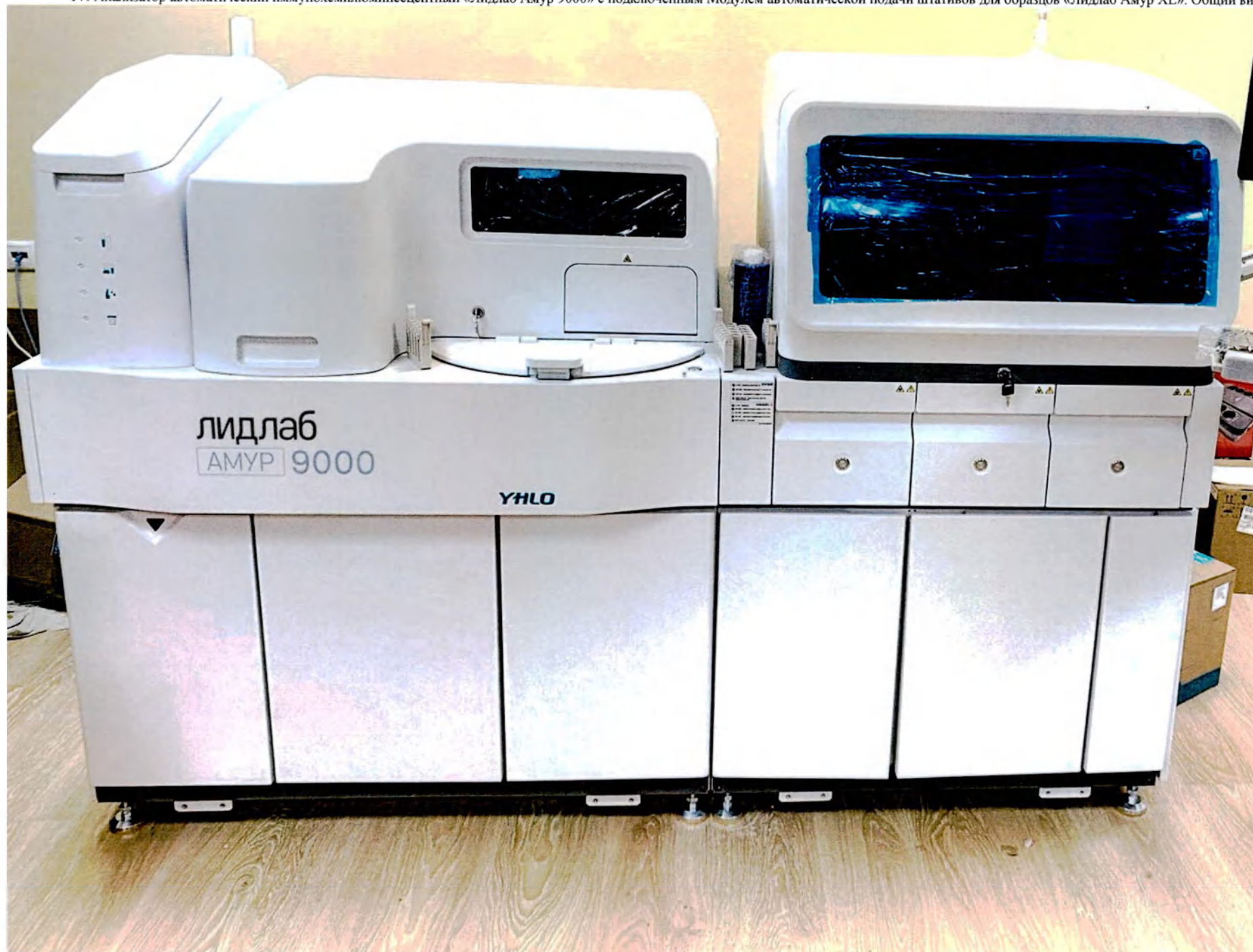
IV. Анализатор автоматический иммунохемилюминесцентный «Лидлаб Амур 9000» с подключенным Модулем автоматической подачи штативов для образцов «Лидлаб Амур XL». Общий вид
