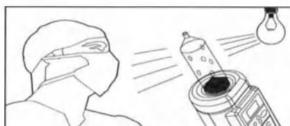
Рис. 9—4. Правильное освещение индикаторов FluiDots
