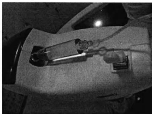
Рисунок 14 – Установка шприца в манипулятор
