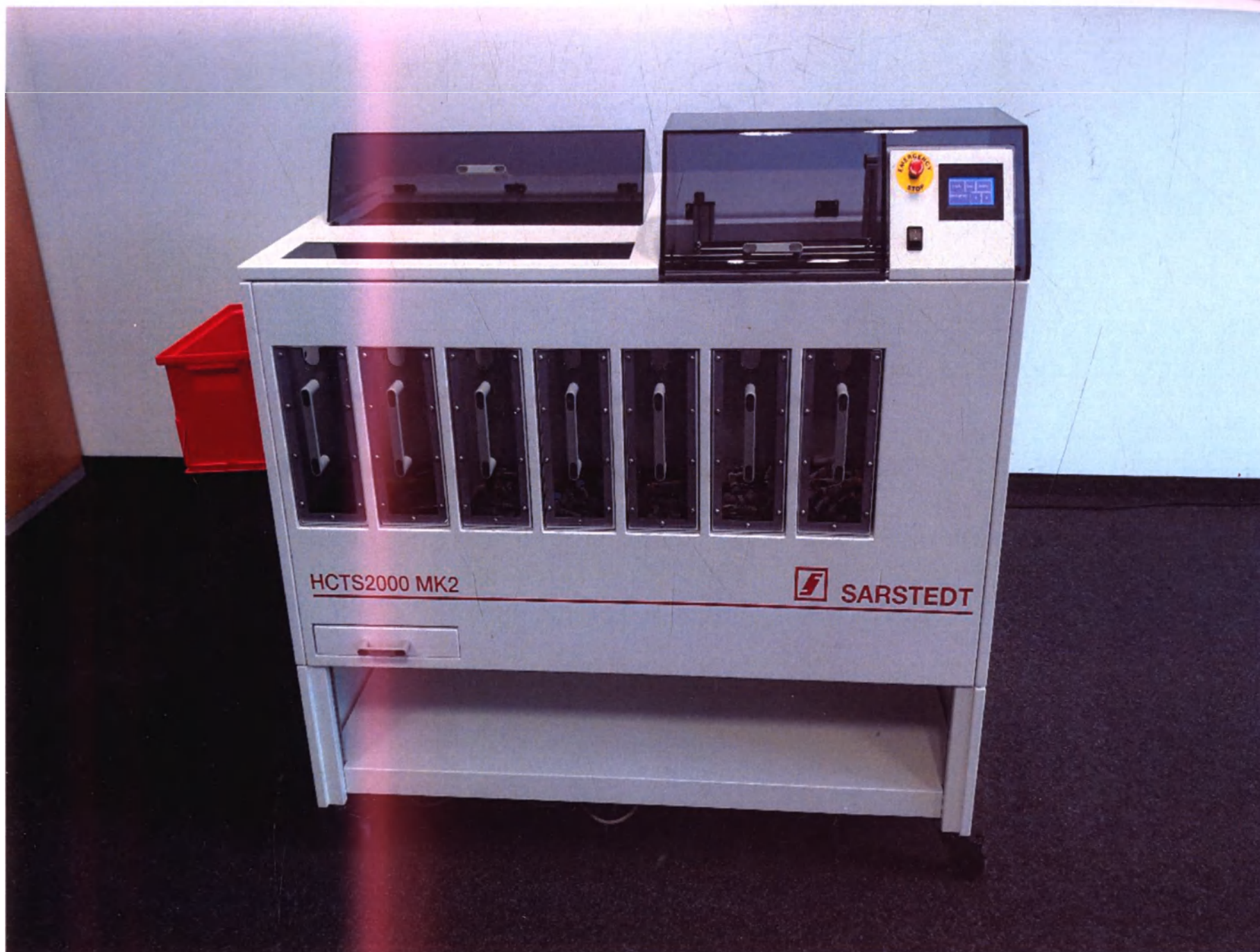
1. Система автоматизированная загрузки россыпью и сортировки образцов биологических материалов HCTS2000 MK2: общий вид изделия
