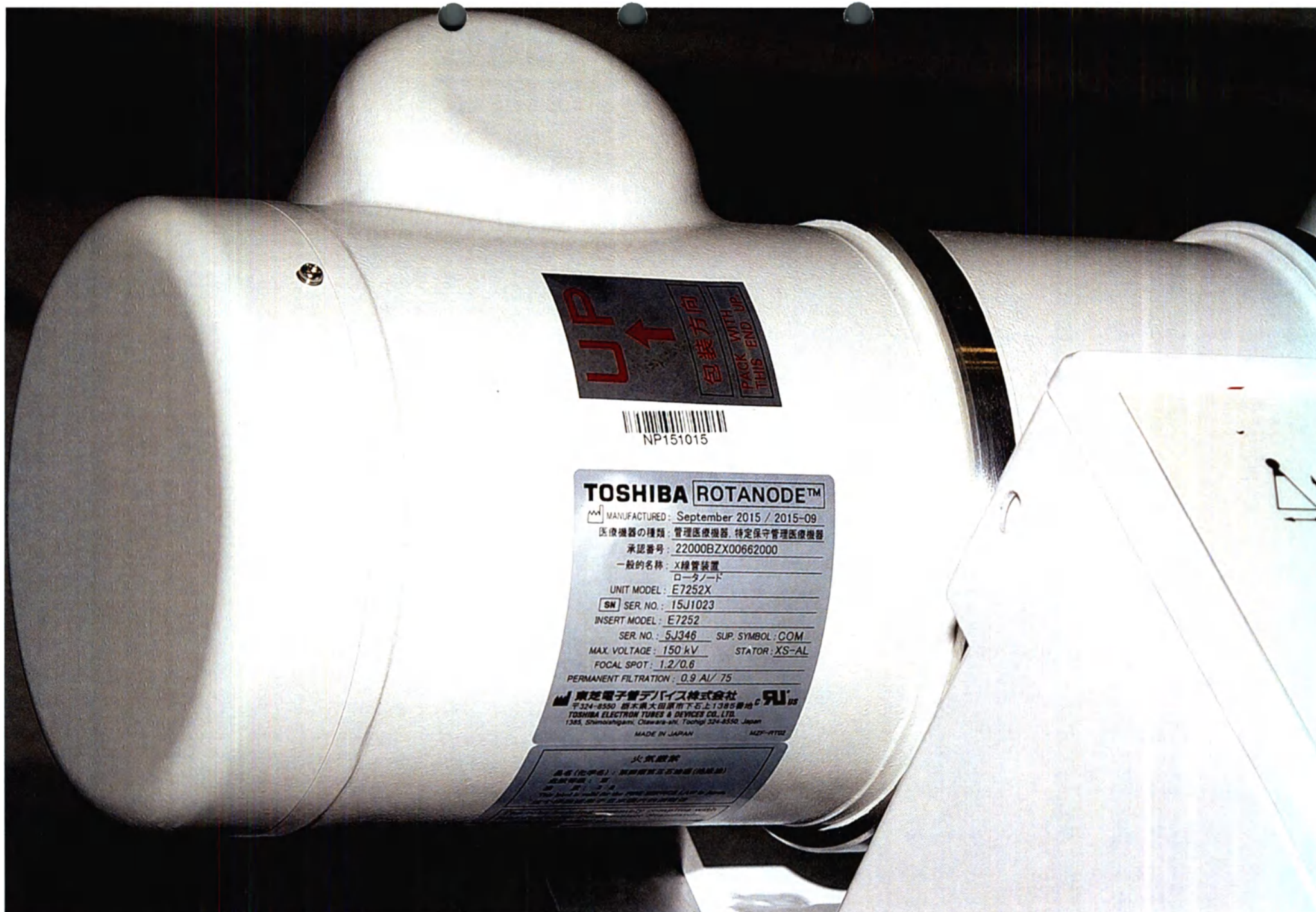
Фотография 9 – Излучатель рентгеновский. Маркировка
