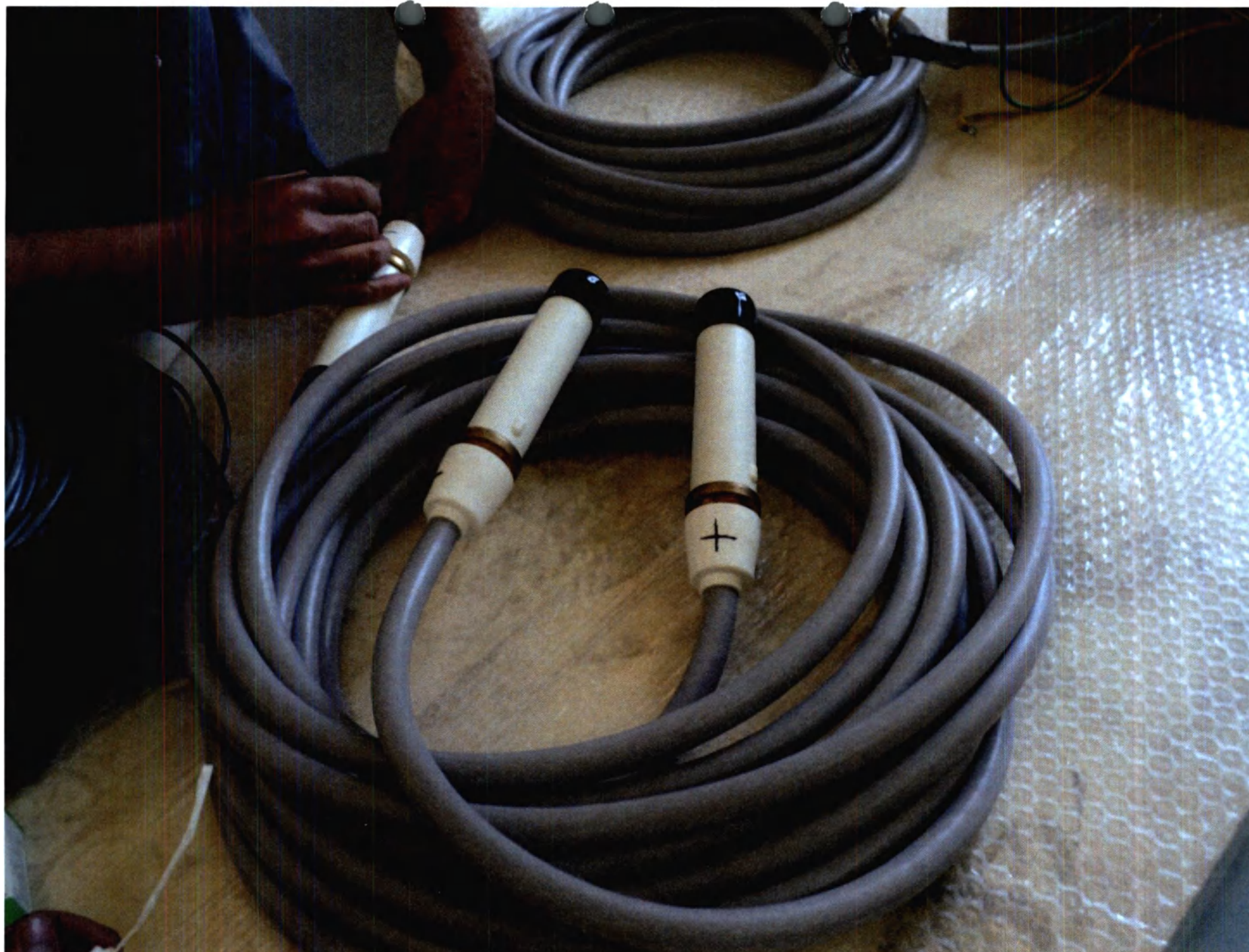
Фотография 7 – Кабель высоковольтный с комплектом монтажных частей
