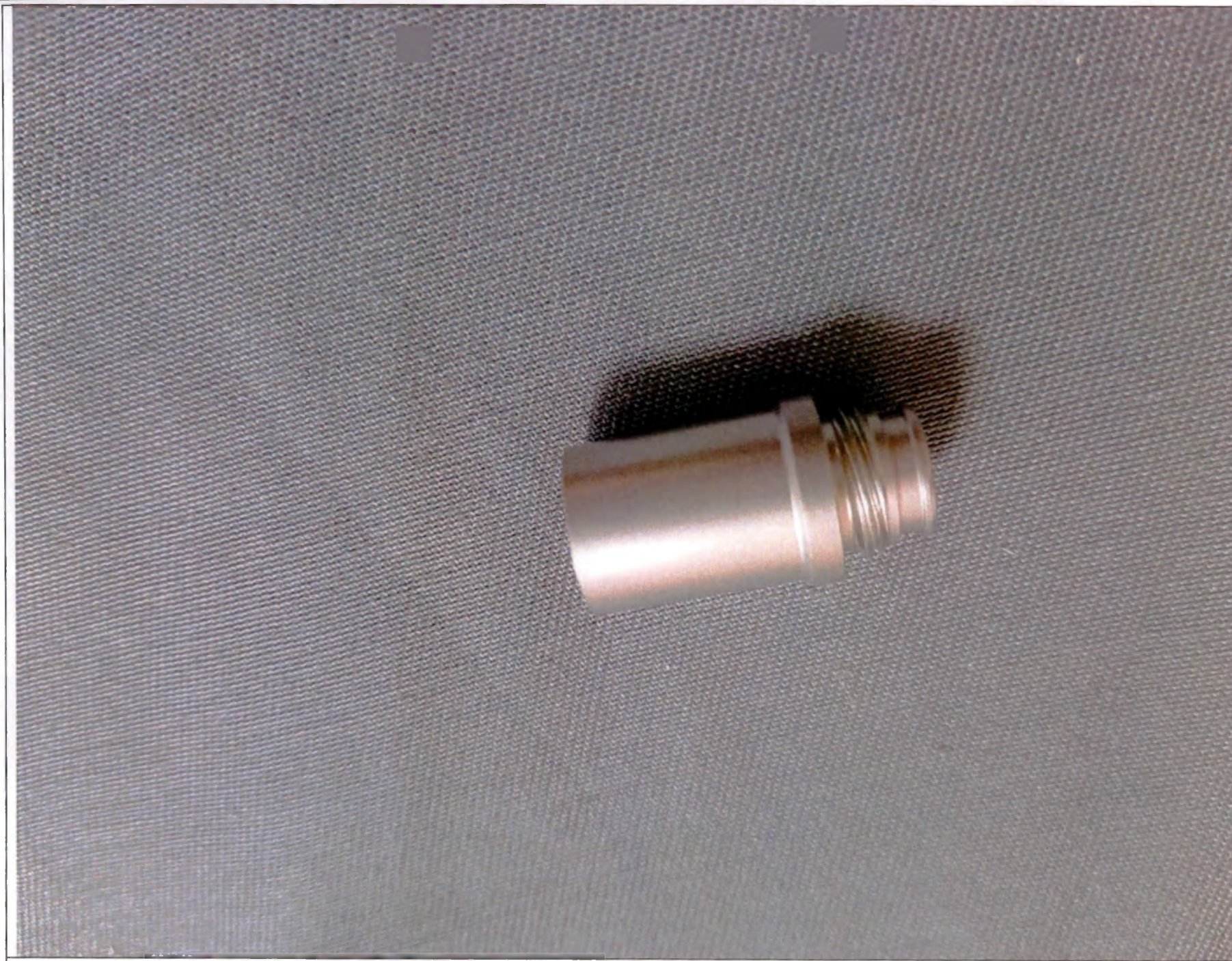
Рис. 49. Адаптер световодов KARL STORZ и Olympus.
