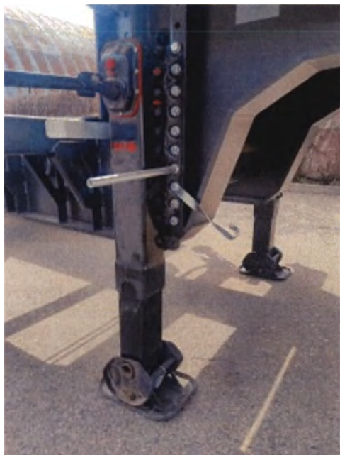
Рисунки 17, 17.1. Установка опор кузова специальным ключом.
