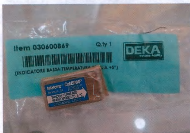
Рисунок 57 - Регистратор низкой температуры, модель CT5C-D, производства Telatemp, США
