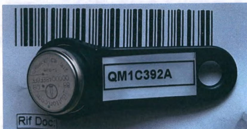
Рисунок 40 – Ключ системный, REF 041400050, производства DEKA M.E.L.A S.r.l. (типа i-button)
