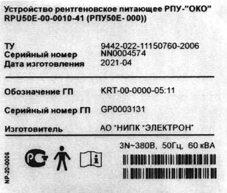
Рисунок 8.3 – Образец маркировочной таблички компонента комплекса КРТ, изготовленного по собственным техническим условиям (ТУ)
