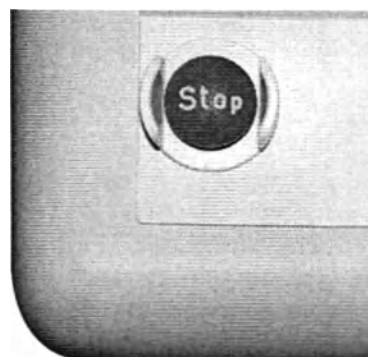
Рисунок 3.9 – Аварийный выключатель на ТСШ
