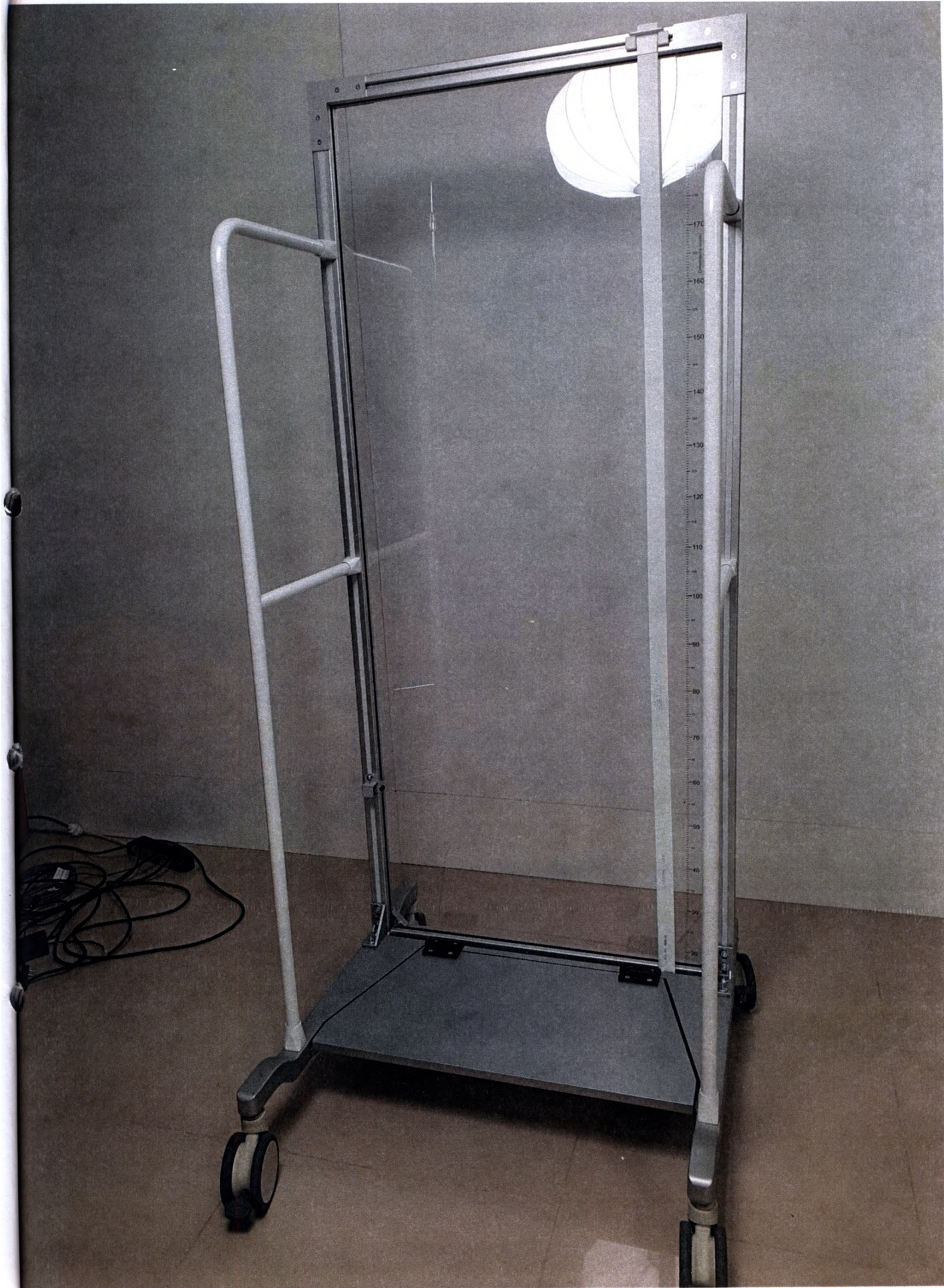
Фотография 12 – Система позиционирования рентгеновская серии Roesys XRS (из состава Стойки)
