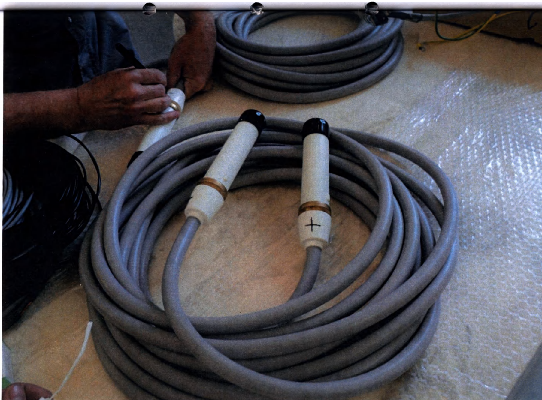
Фотография 19 – Кабель высоковольтный с комплектом монтажных частей
