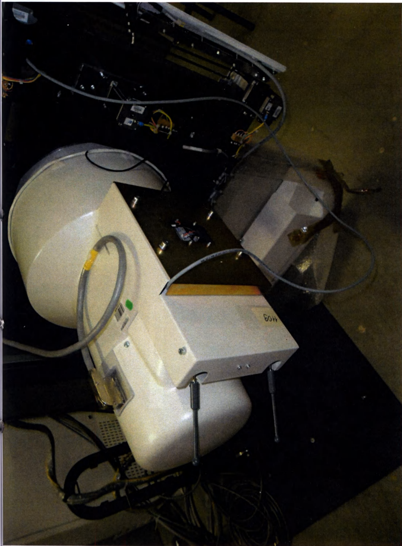
Фотография 23 – УРИ. Усилитель рентгеновского изображения УРИ. ТУ 9442-027-11150760-2007 (в условиях эксплуатации закрыт кожухом)
