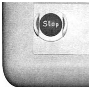
Рисунок 3.9 – Аварийный выключатель на ТСЦ
