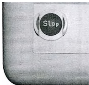
Рисунок 3.9 – Аварийный выключатель на ТСШ
