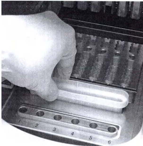
Установка контейнера для отработанных наконечников
