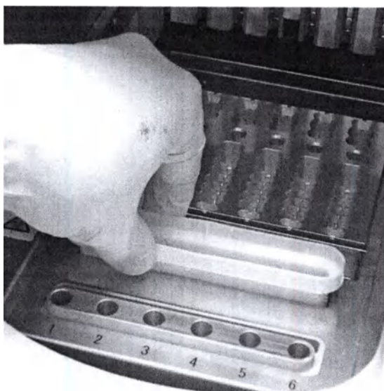
Установка контейнера для отработанных наконечников
