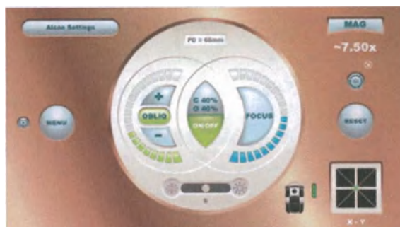
Рисунок 2-19 Только наклонное освещение, баланс выделен серым (не доступен)
