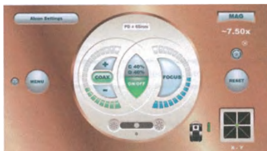
Рисунок 2-18 Только ковоксальное освещение, баланс выделен серым (не доступен)
