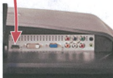
Рисунок 6-8 Соединение блока управления камеры Panasonic 3MOS/CCD HD с монитором
