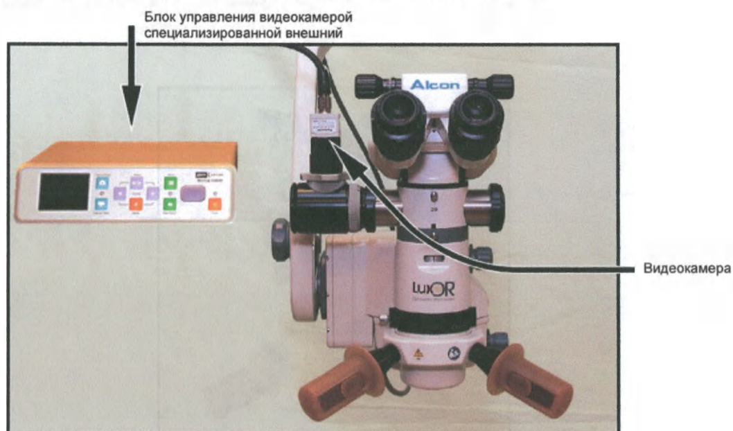
Рисунок 6-5 Установка видеокамеры и Блока управления
