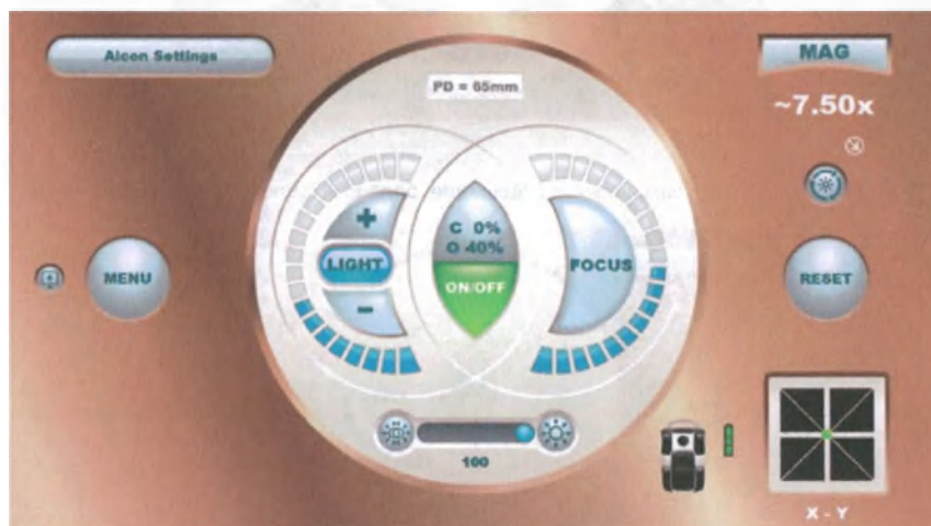
Рисунок 2-20 Коаксиальное и наклонное вместе (режим «Свет»), баланс установлен на 100% наклонное освещение
