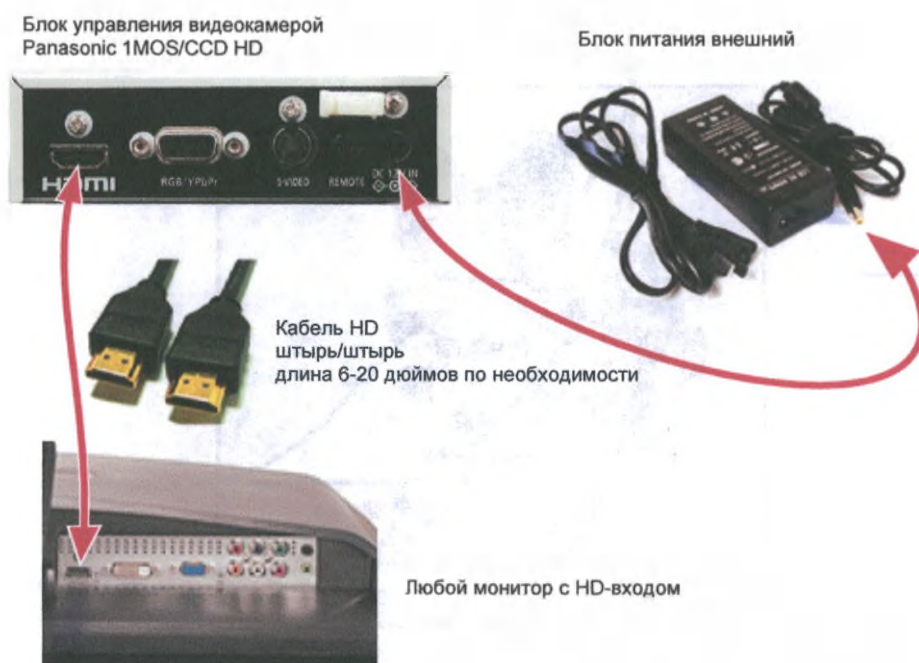
Рисунок 6-6 Соединение блока управления камеры 1MOS/CCD HD с монитором
