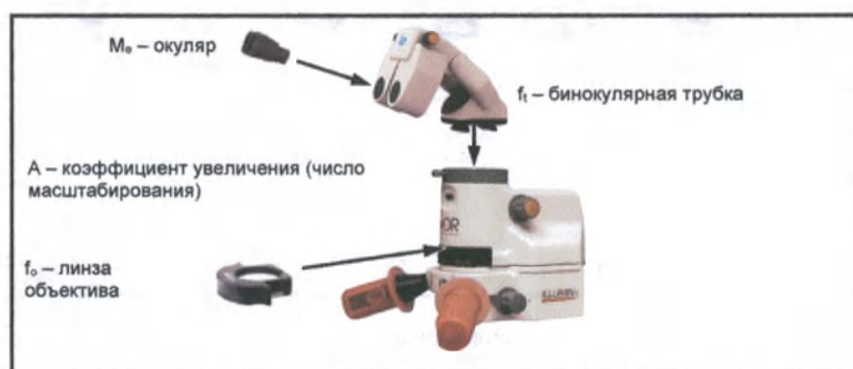
Рисунок 2-28 Формула M = f_t / f_o \times M_o \times A
