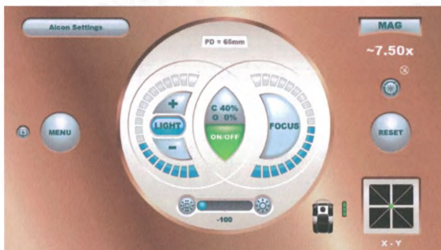
Рисунок 2-21 Коаксиальное и наклонное вместе (режим «Свет»), баланс установлен на 100% коаксиальное освещение
