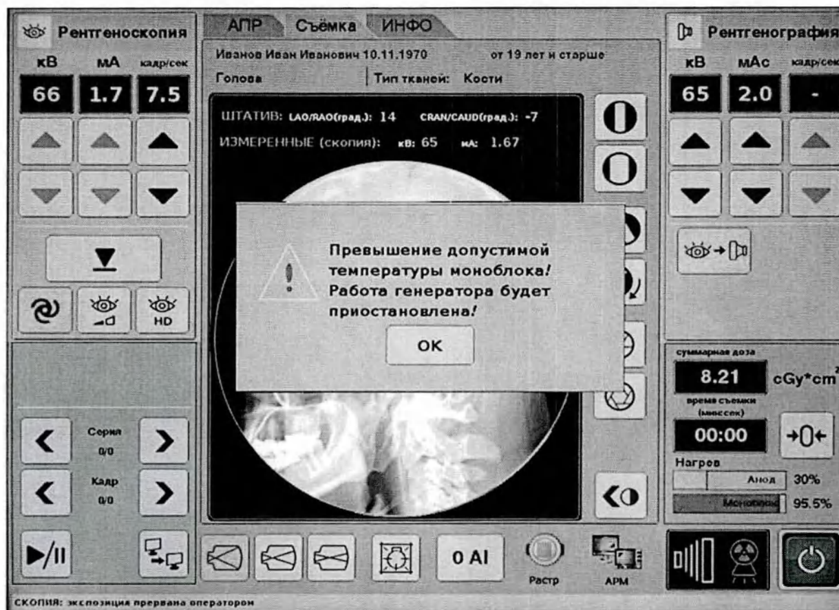
Рисунок 4.4 – Индикация критического нагрева моноблока
