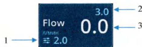
1 – установленное значение потока Flow; 2 – верхний предел значения потока Flow относительно установленного для срабатывания аварийной сигнализации; 3 – измеренное значение потока Flow Рисунок 78 – Кнопка параметра Flow в режиме «HFNC»
