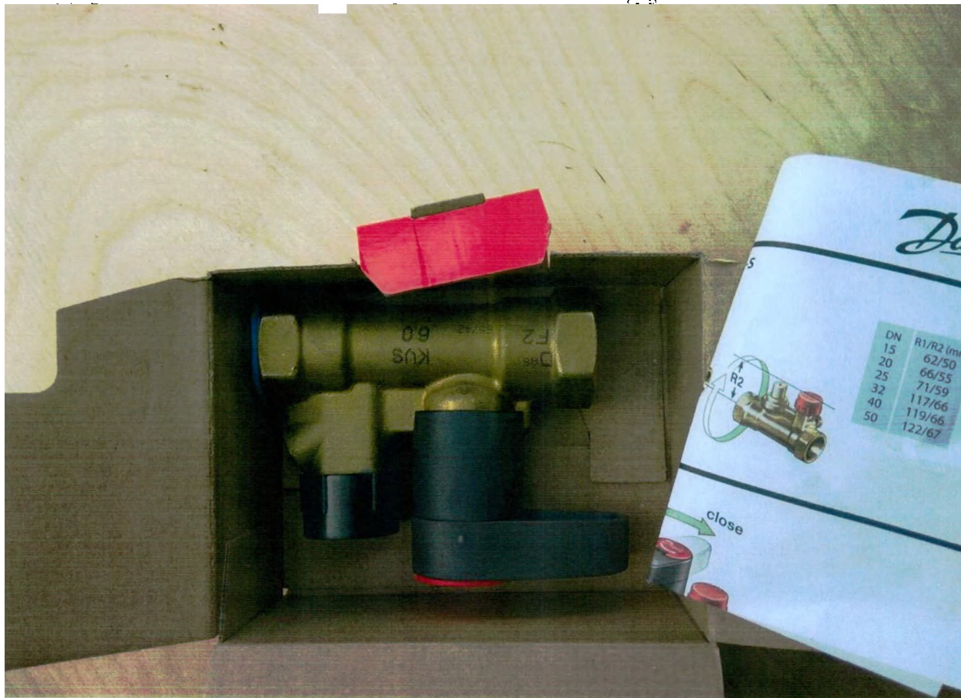
Клапаны запорные MSV-S, производства «Danfoss A/S» (Дания)
