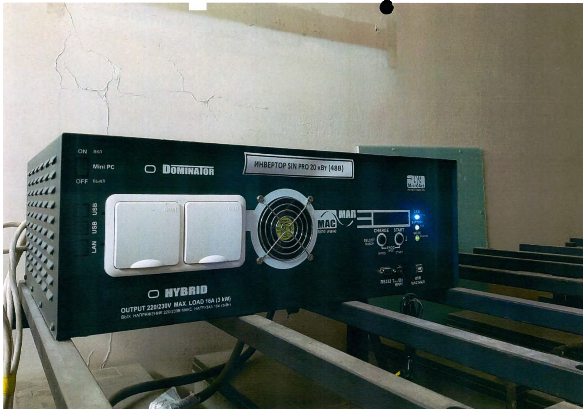
Многофункциональный автономный преобразователь энергии, тип: МАП SINE, производства ООО «МИКРОАРТ ПРО», ТУ 26.20.40-001-44635449-2020 (РФ)
