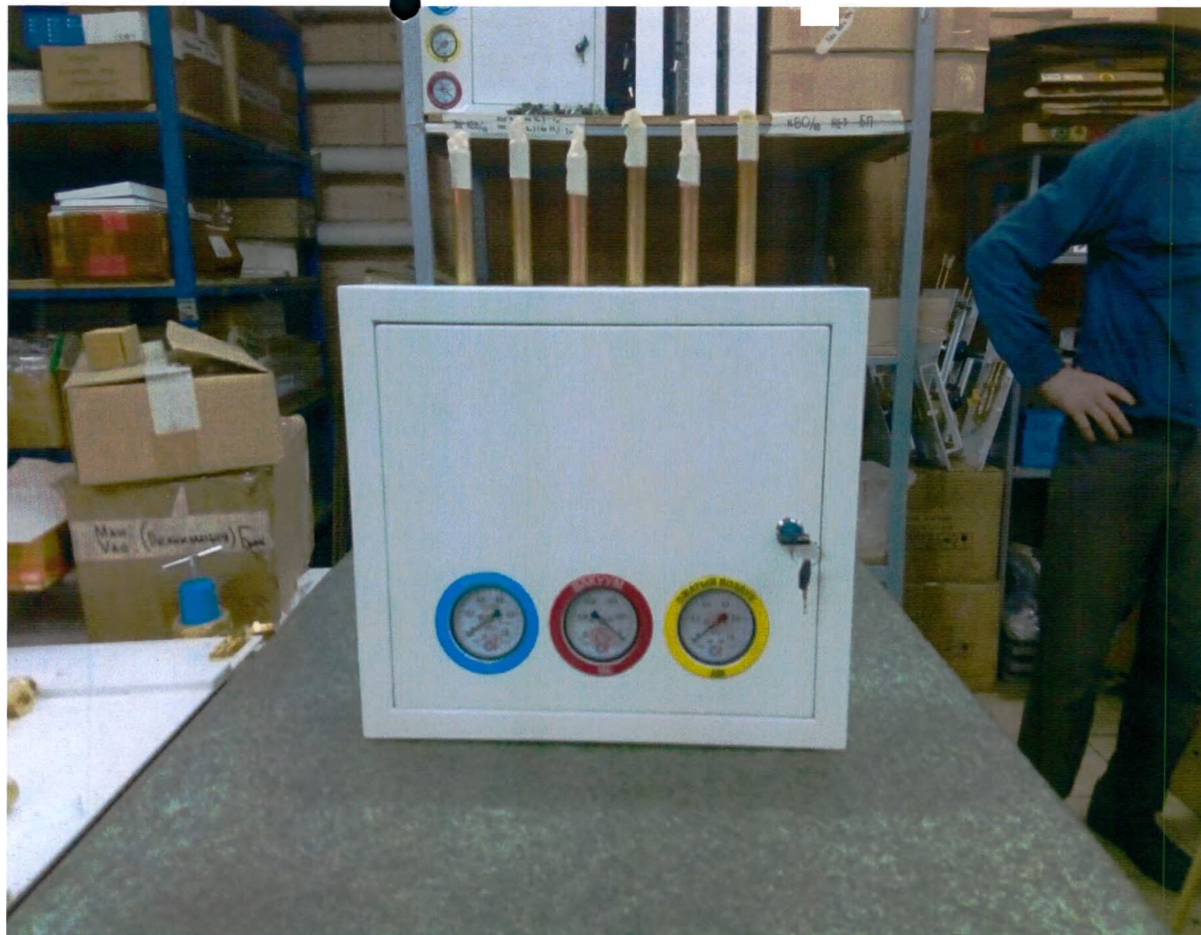
Рампа разрядная газовая медицинского назначения РРГ, производства Корпорация СоТиС (РФ)
