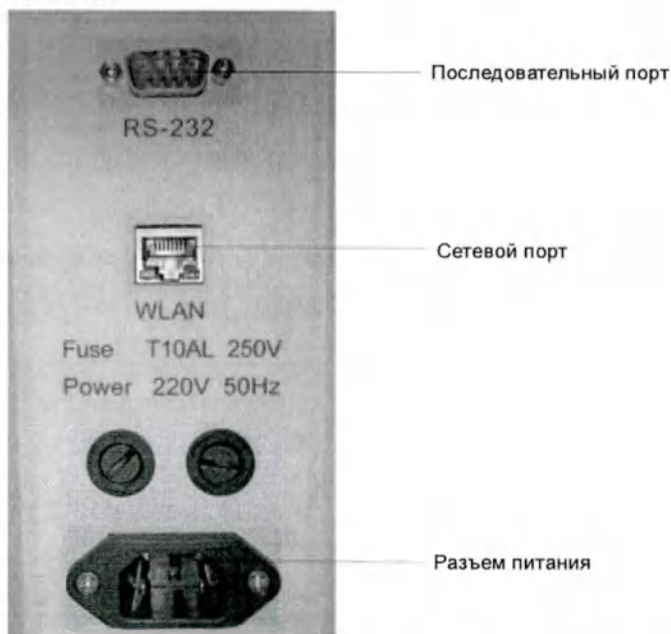
Рисунок 1-5 Последовательный порт, сетевой порт и разъем питания на задней стороне аналитического модуля
