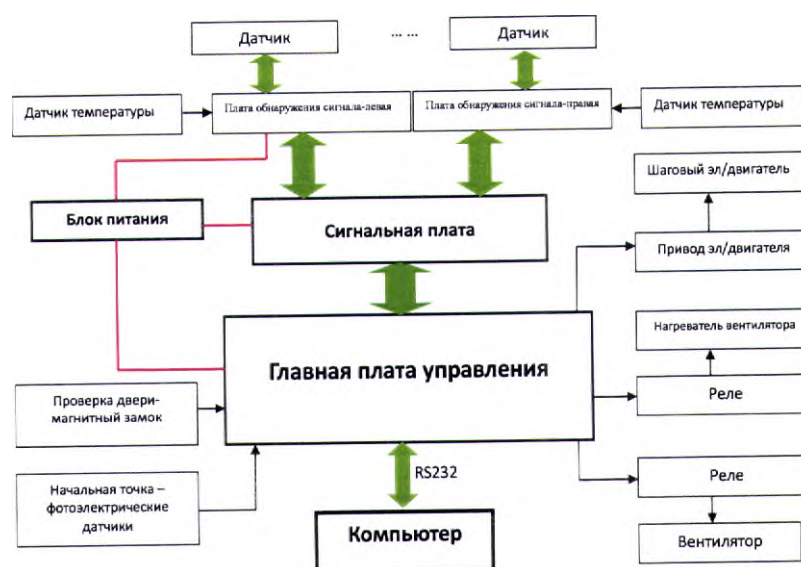
Рис. 9 - Принципиальная схема работы анализатора LABSTAR 100
