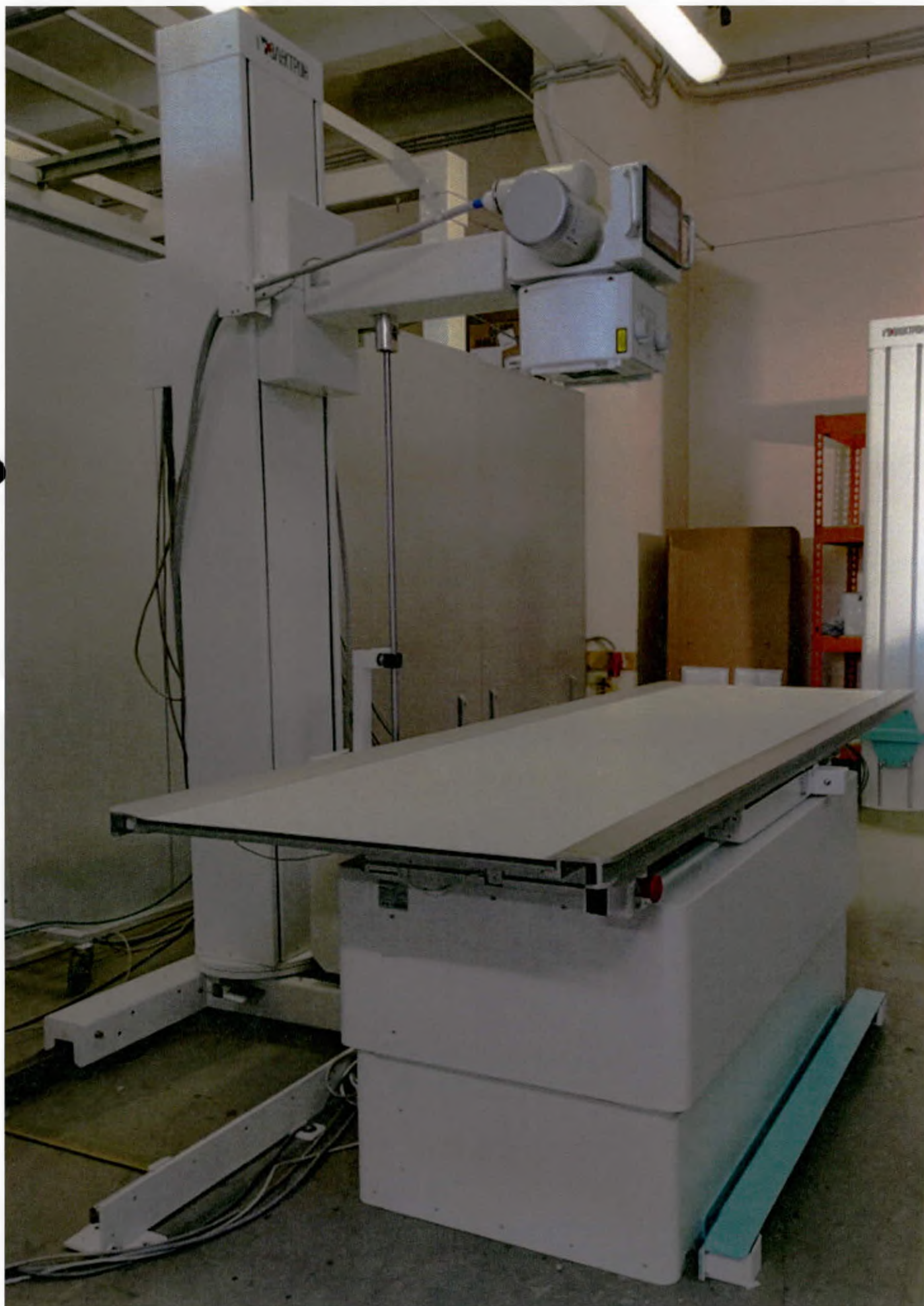
Фотография 10 – Штатив RDK по спецификации, включающей Систему позиционирования рентгеновскую в комплектации со Столом со штативом снимков TOMOC в исполнении TOMOC-ДЕ
