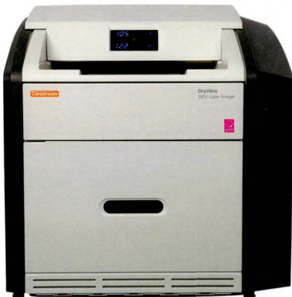
Фотография 70 – Камера лазерная мультиформатная серии DRYVIEW для печати медицинских изображений
