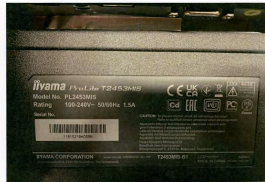
Фотография 79 – Мониторы модели серии ProLite T2453MTS, ProLite T2453MIS и маркировка
