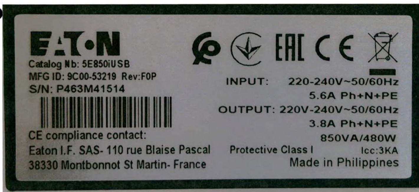
Фотография 80 – Источник бесперебойного питания EATON и маркировка
