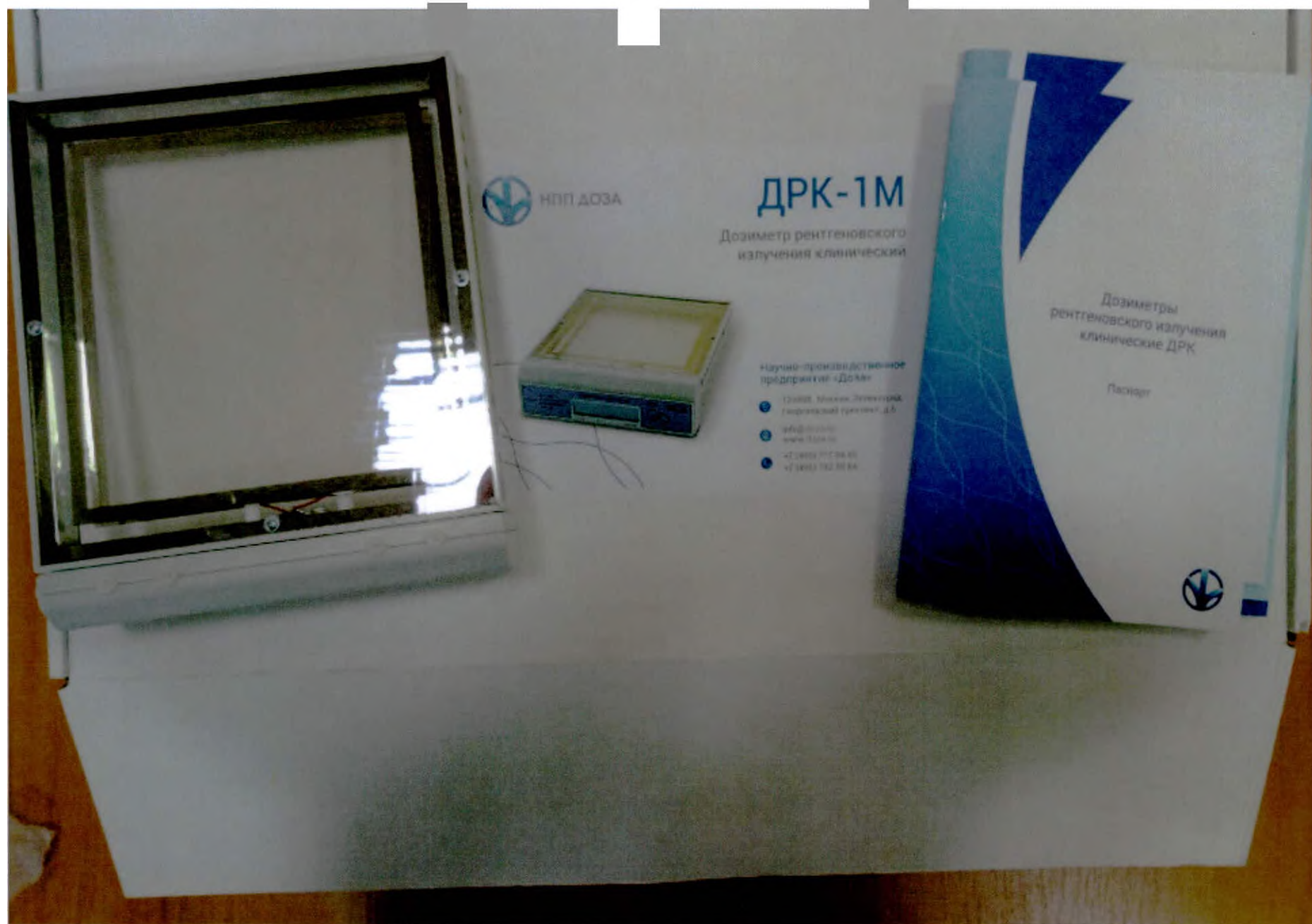
Фотография 92 – Дозиметр рентгеновского излучения клинический ДРК-1М по ТУ 9441-109-31867313-2012, НПП «Доза», Россия
