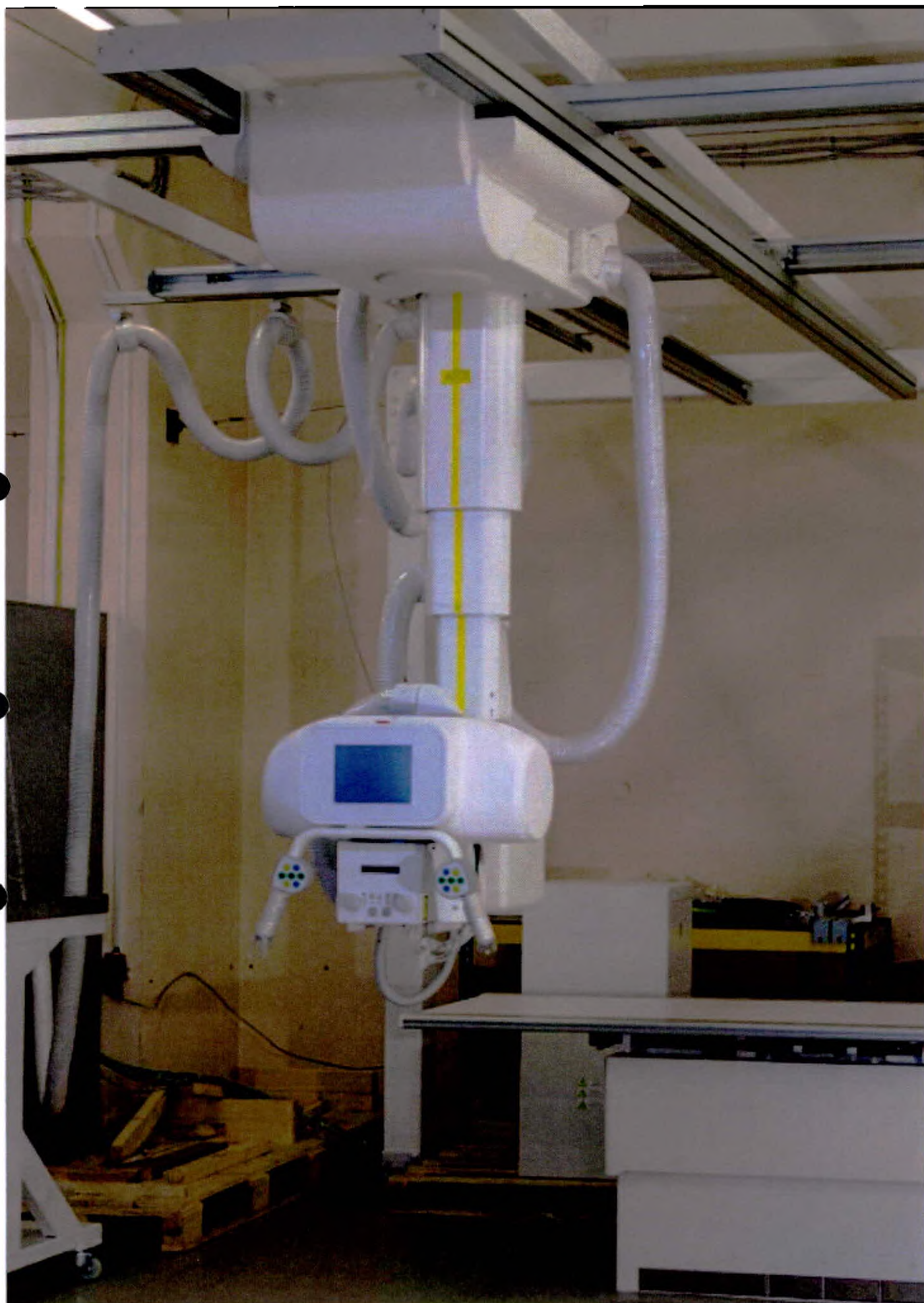
Фотография 24 – Кронштейн с излучателем в сборе по спецификации включающей Систему позиционирования серии MSP-EV/EL, Излучатель RTC 700HS, IAE и Коллиматор серии Ralco R 225 ACS DHHS
