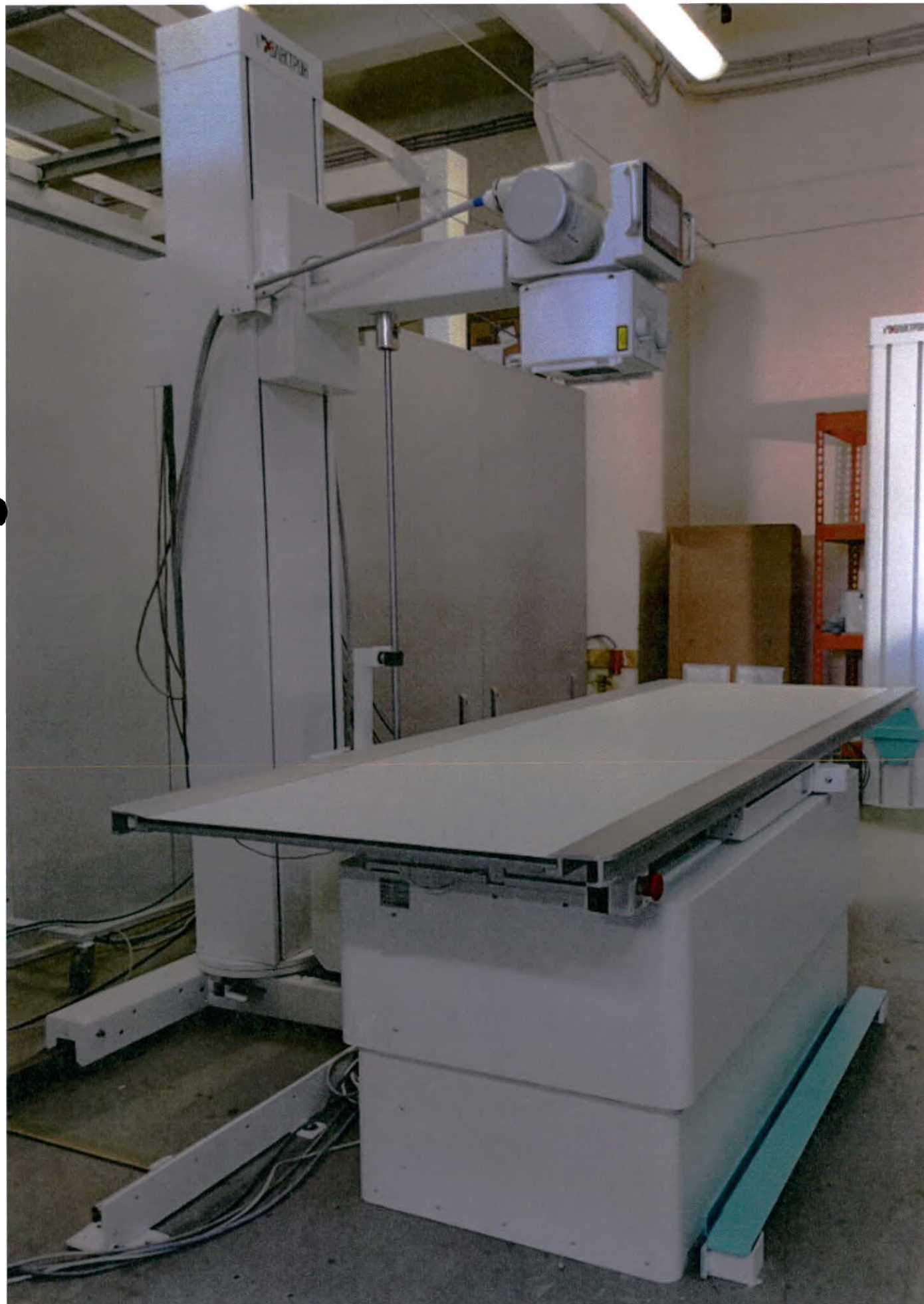
Фотография 10 – Штатив RDK по спецификации, включающей Систему позиционирования рентгеновскую в комплектации со Столом со штативом снимков ТОМОС в исполнении ТОМОС-ДЕ
