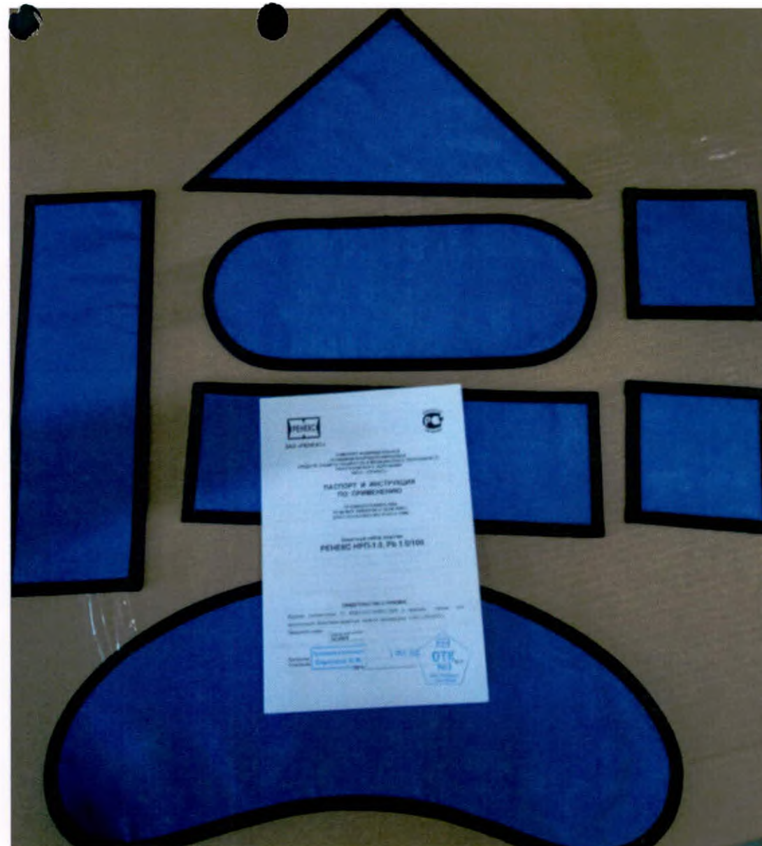
Фотография 96 – Образцы из Комплекта индивидуальных поливинилхлоридно-свинцовых средств защиты пациентов и медицинского персонала от рентгеновского излучения РУ № ФСР 2008/03184, ЗАО «Ренекс»
