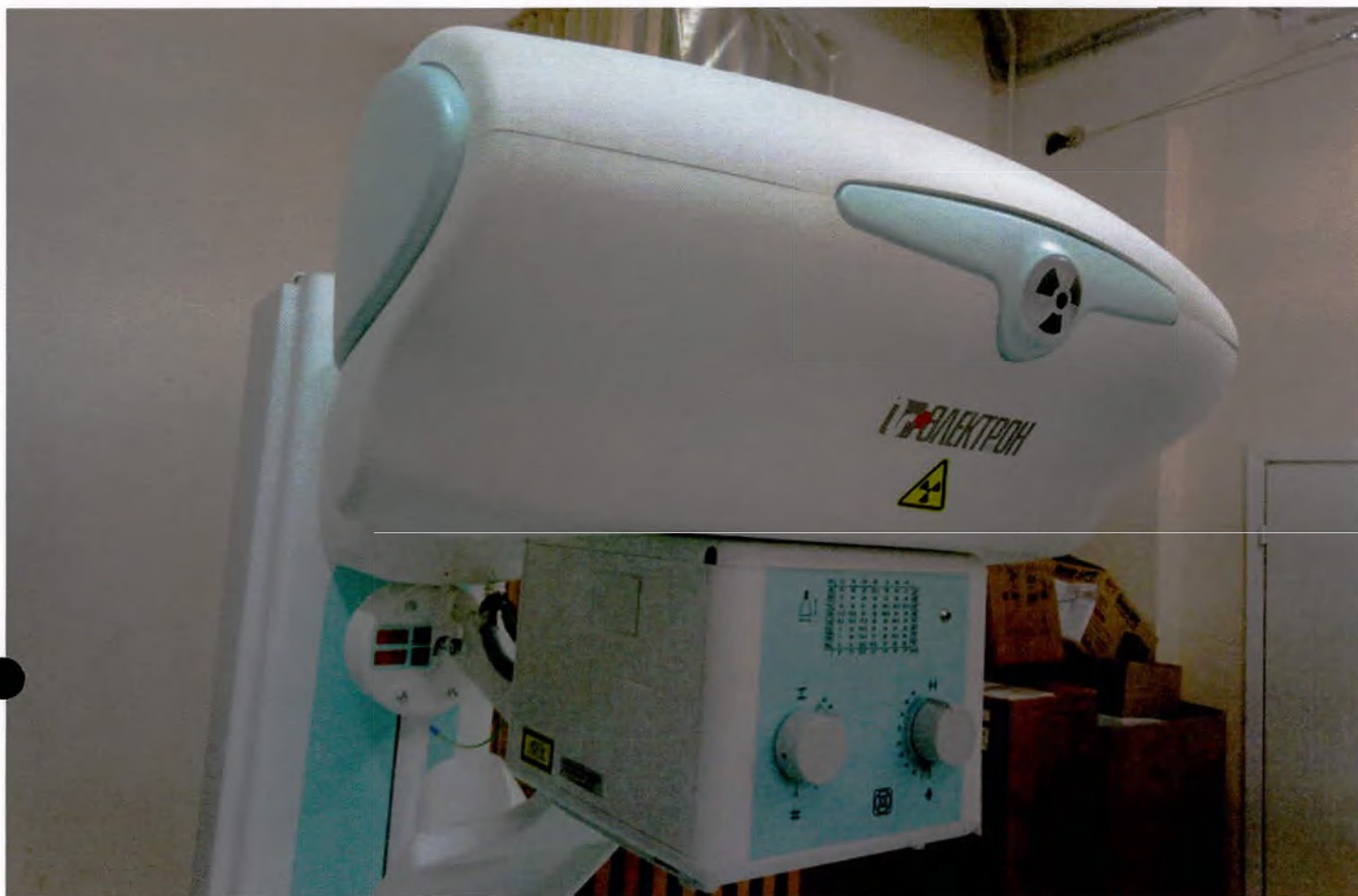
Фотография 16 – Коллиматор Ralco серии R 302/A и излучатель серии ИРД (под декоративной крышкой)
