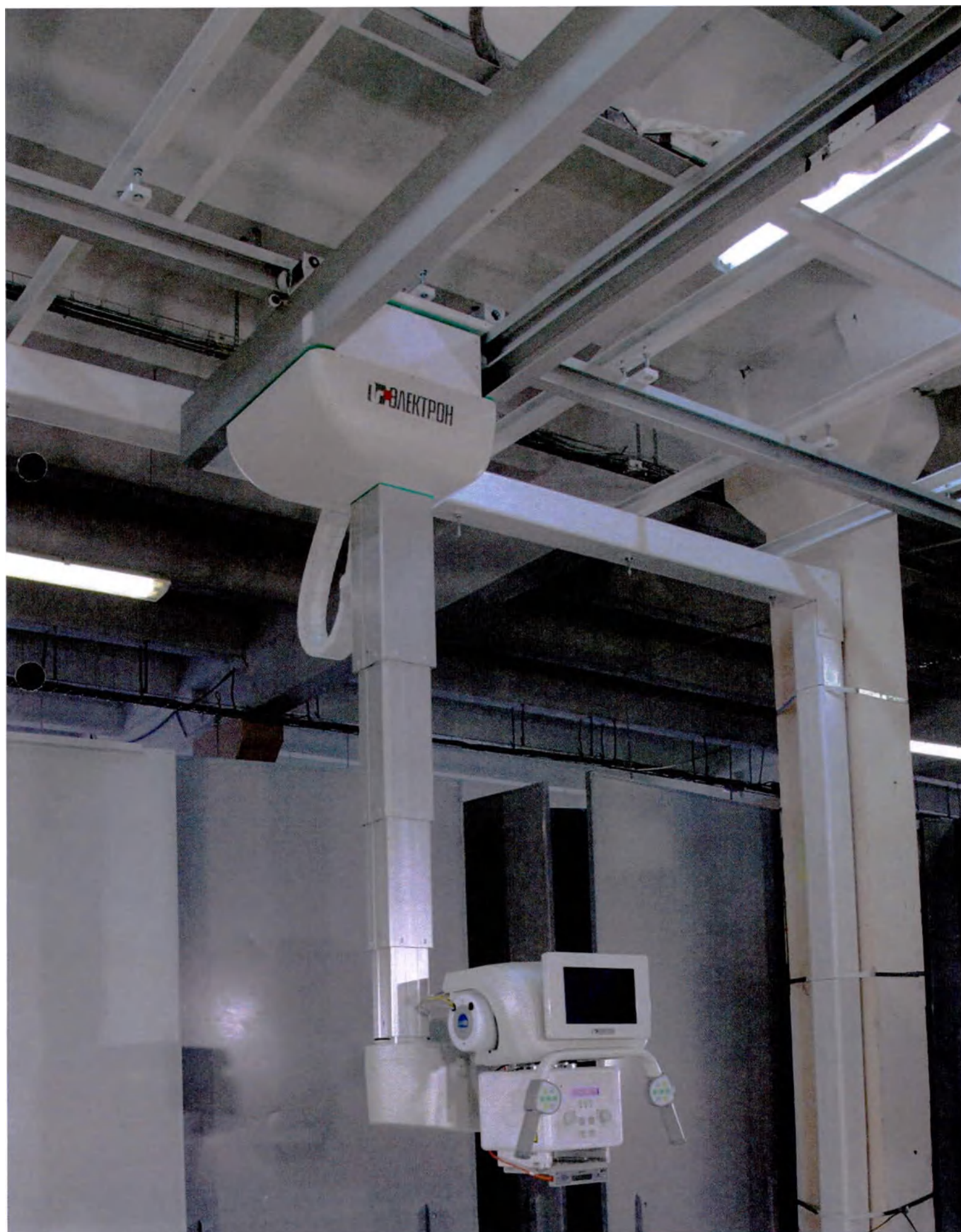
Фотография 25 – Кронштейн с излучателем в сборе по спецификации включающей Систему позиционирования серии Vision, включающий излучатель RTM101HS, IAE, коллиматор серии Ralco R
