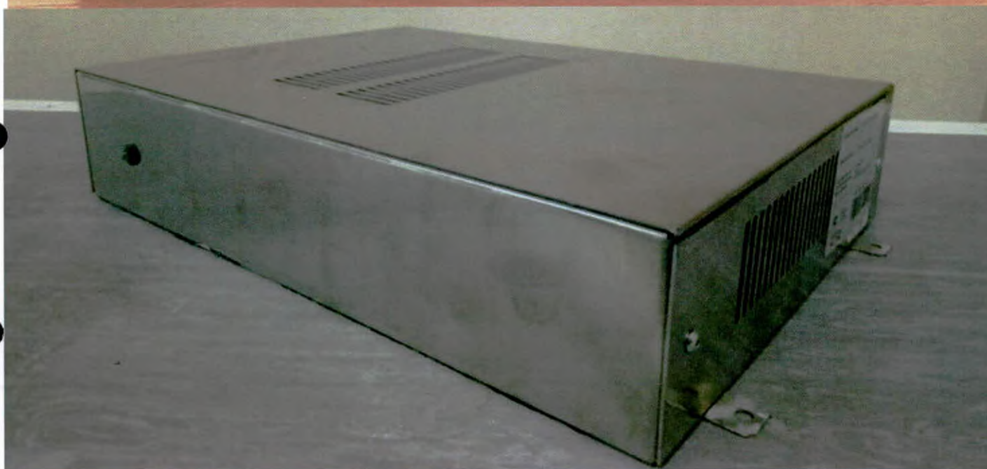
Фотография 59 – Блок питания камеры (детектора)
