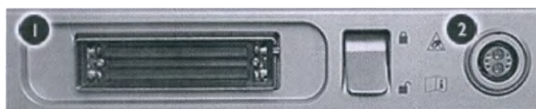
Рисунок. 7. Основное гнездо для подключаемого напрямую датчика (1) и разъем многопортового адаптера (2).
