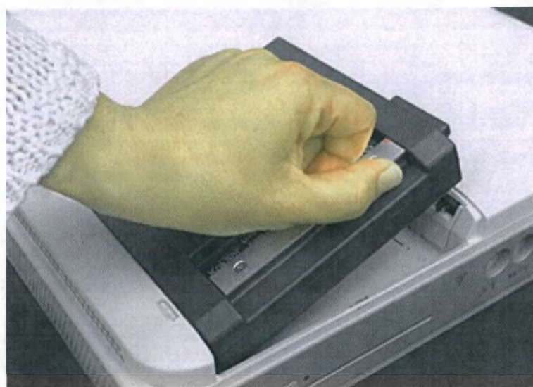
Рисунок. 17. Установка аккумуляторной батареи в основной блок системы.
