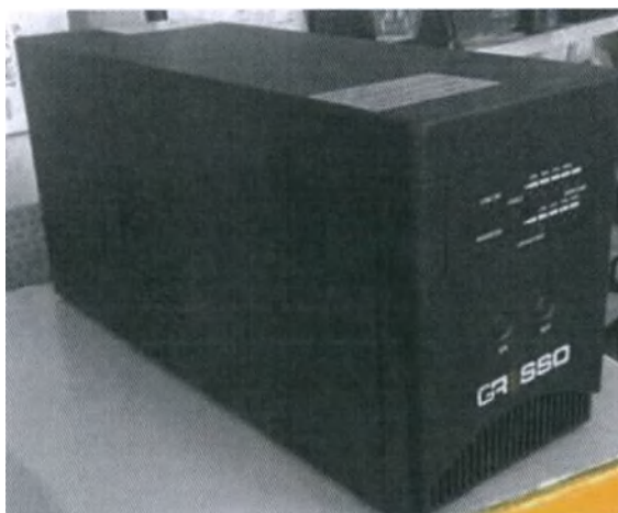
Рисунок. 61. Устройство обеспечения бесперебойного питания.
