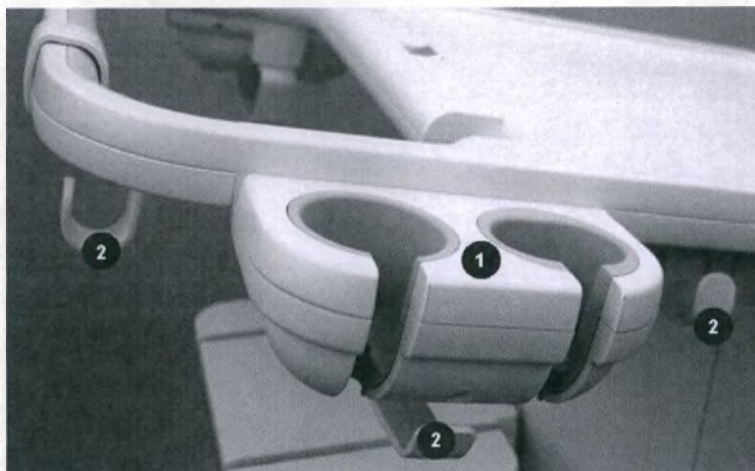
Рисунок. 12. Держатели датчиков и захваты кабелей на тележке.
