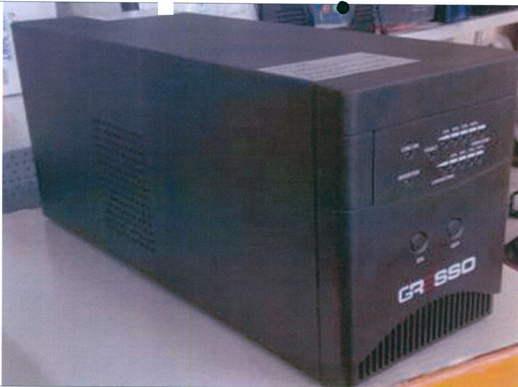
16. Устройство обеспечения бесперебойного питания
