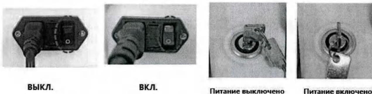
Рисунок 18 – Положение кнопки выключателя питания ВКЛ/ВЫКЛ, положение ключа запуска
