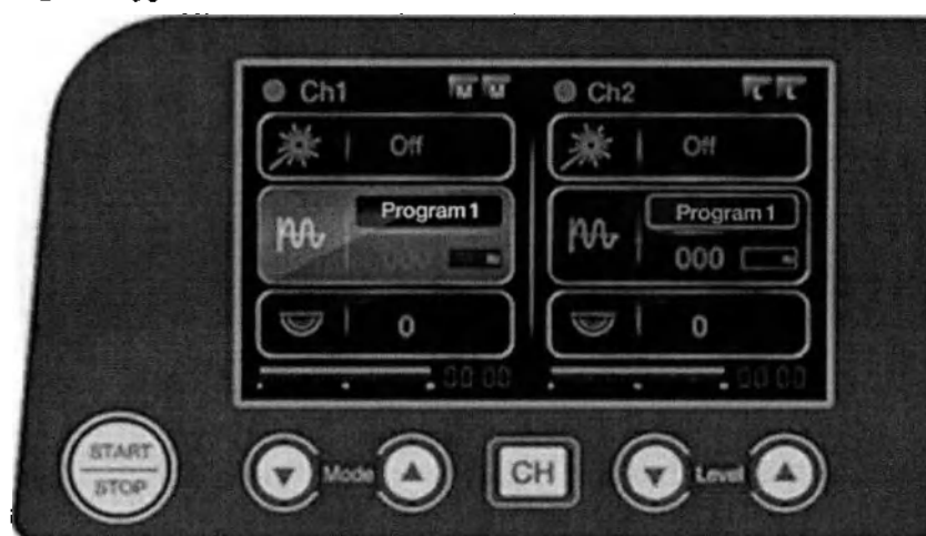
Рисунок 21 – Экран устройства в режиме НЧ-воздействия
