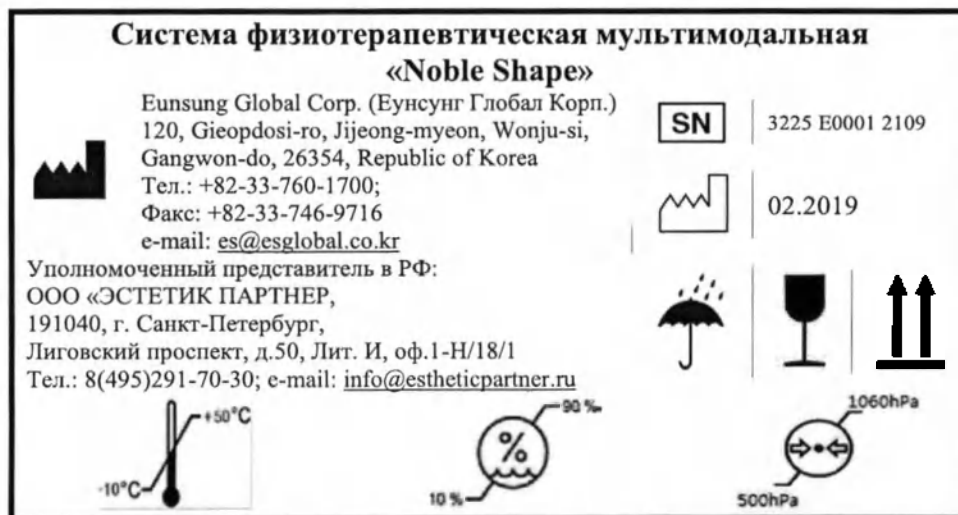
Рисунок 37 – Образец транспортной маркировки
