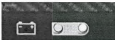
Рисунок 2.1 – Вид индикатора заряда батареи и разъема INTERFACE на боковой стенке детектора «СОЛО ДР-МТ» в беспроводном исполнении
