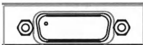
Рисунок 2.5 – Разъем DB15 стационарного детектора во встроенном исполнении Pixium RF4343 или Pixium RF4343FL на панели разъемов
