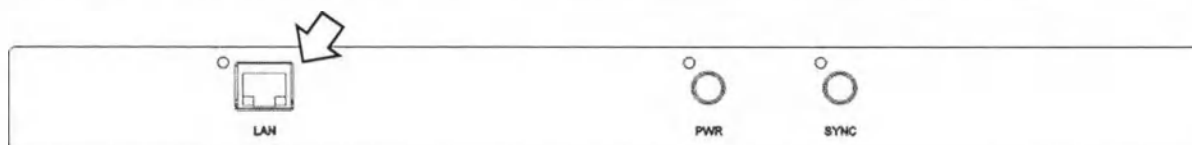
Рисунок 2.9 – Разъем подключения детектора «СОЛО ДР-МТ» в стационарном исполнении к АРМ лаборанта на панели разъемов
