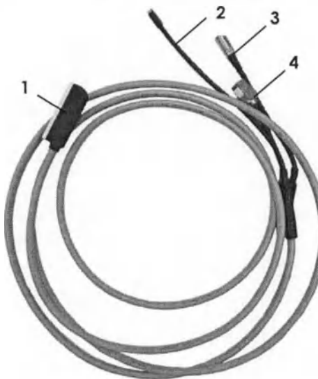
Рисунок 1.18 – Низковольтный кабель стационарного детектора исп. 3.1, 3.2, 3.3
