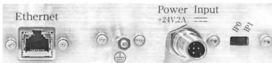
Рисунок 2.11 – Разъем Ethernet стационарного детектора во встроенном исполнении FDX4343R на панели разъемов
