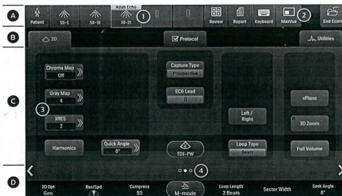
Сенсорный экран для расширенного интерфейса пользователя кардиологических исследований
