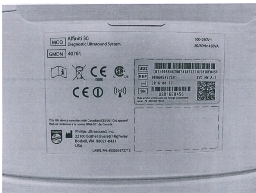
Рисунок 139. Пример системной маркировки системы Affiniti 30. (на маркировке сокращение SVC HW B.2 или A.1 обозначают версию сервисного оборудования. Предназначено для внутреннего использования компанией Philips)
