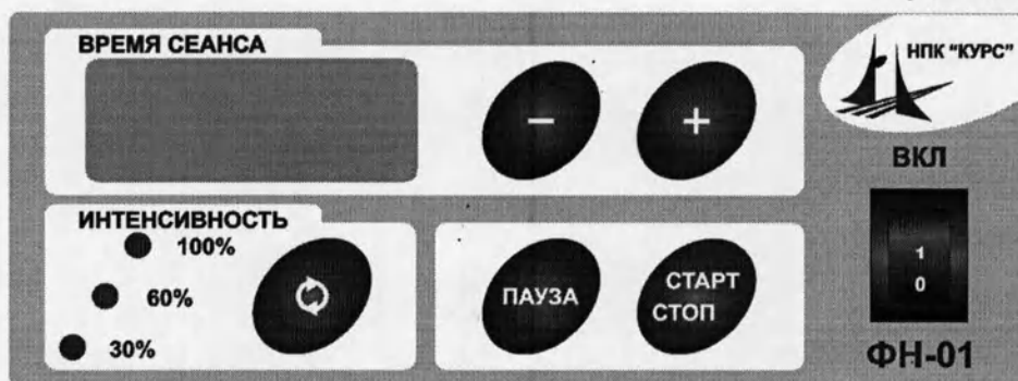
Рисунок 4.1.2 Внешний вид рабочей панели облучателя
